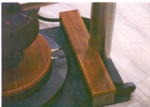
15. Разместите тазовый модуль (приставное сиденье) на основании и подсоедините воздушную трубку и кабель питания
