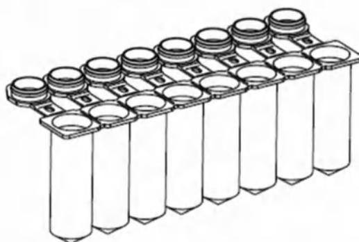
Рисунок 2 – Схематическое изображение Пробирок 1,0 мл в стрипах по 8 шт., с прикрепленными крышками
