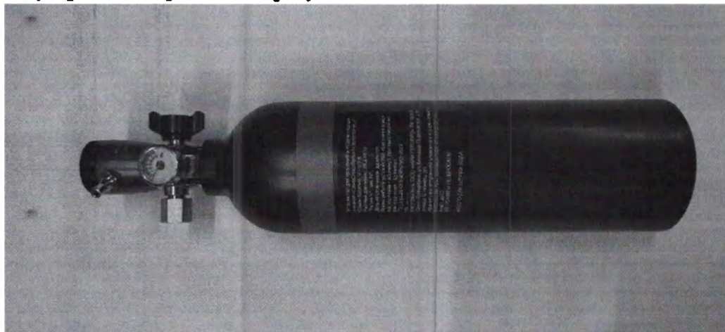
Рисунок 1 - Баллон для хранения и подачи газа с редукционным клапаном в сборе
