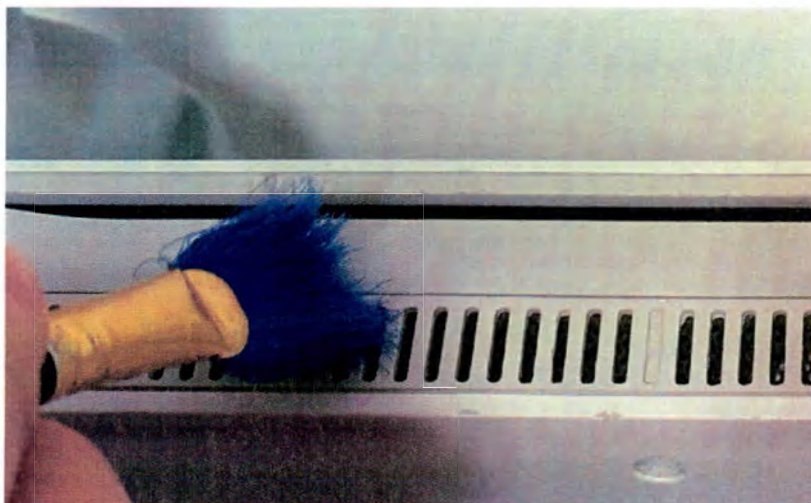
Рис. 12-4. Чистка воздушного фильтра
