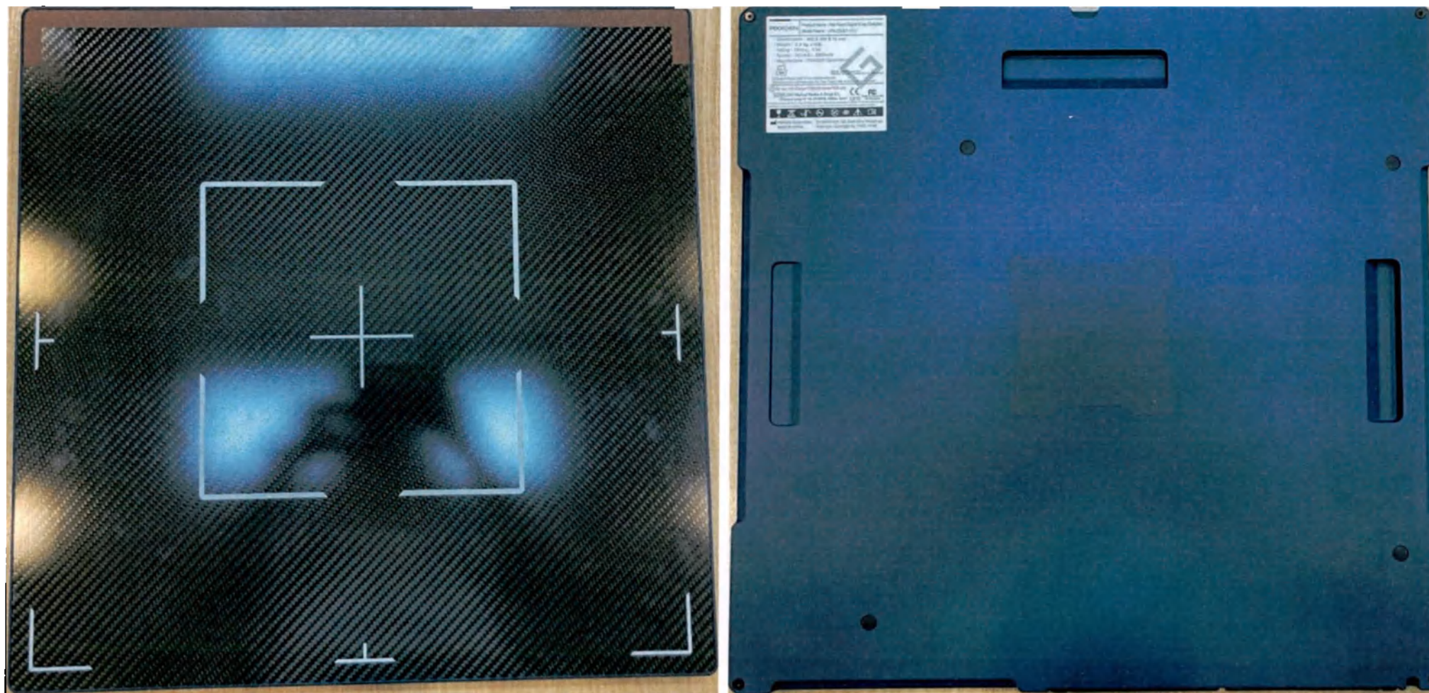
Фотография 103 ~ Цифровой радиографический детектор серии PIXX и серии PRUDENT, PIXXGEN Corporation (в условиях эксплуатации приемник закрыт кожухом штатива). Вариант внешнего вида
