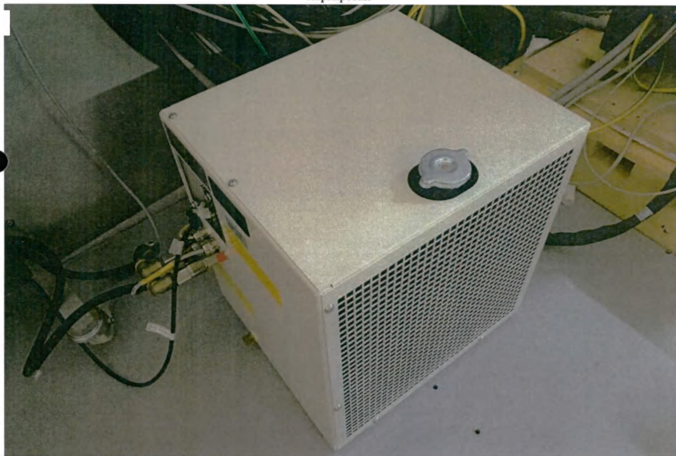
Фотография 32 – Система охлаждения излучателя рентгеновского WL 3000 SU, Siemens Healthcare GmbH (в составе рентгеновского излучателя Siemens Healthcare). Вариант внешнего вида
