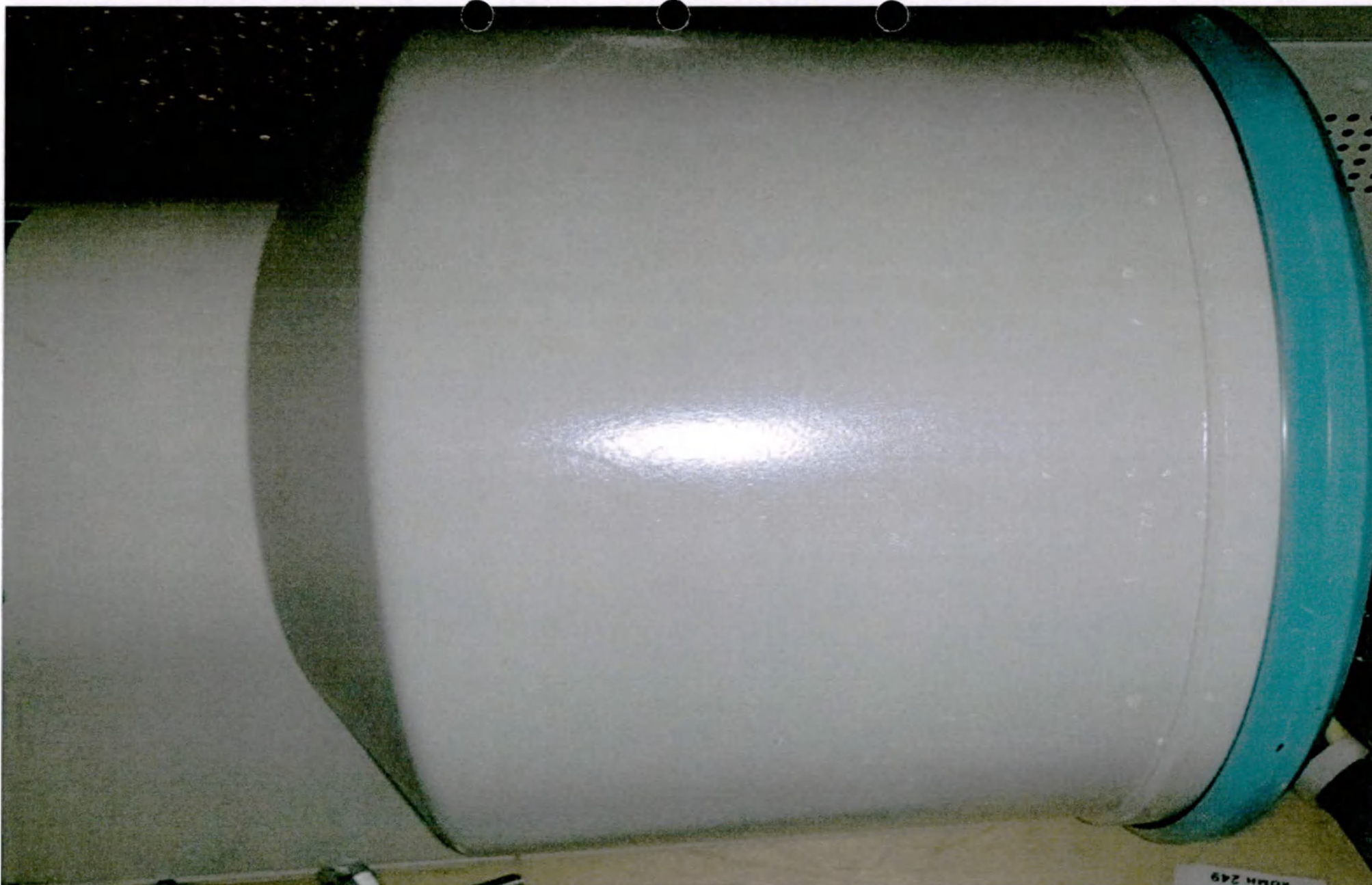
Фотография 94 – Усилитель рентгеновского изображения УРИ, АО «НИПК «Электрон», РУ № ФСР 2008/02453 (при эксплуатации приемник закрыт кожухом штатива). Вариант внешнего вида
