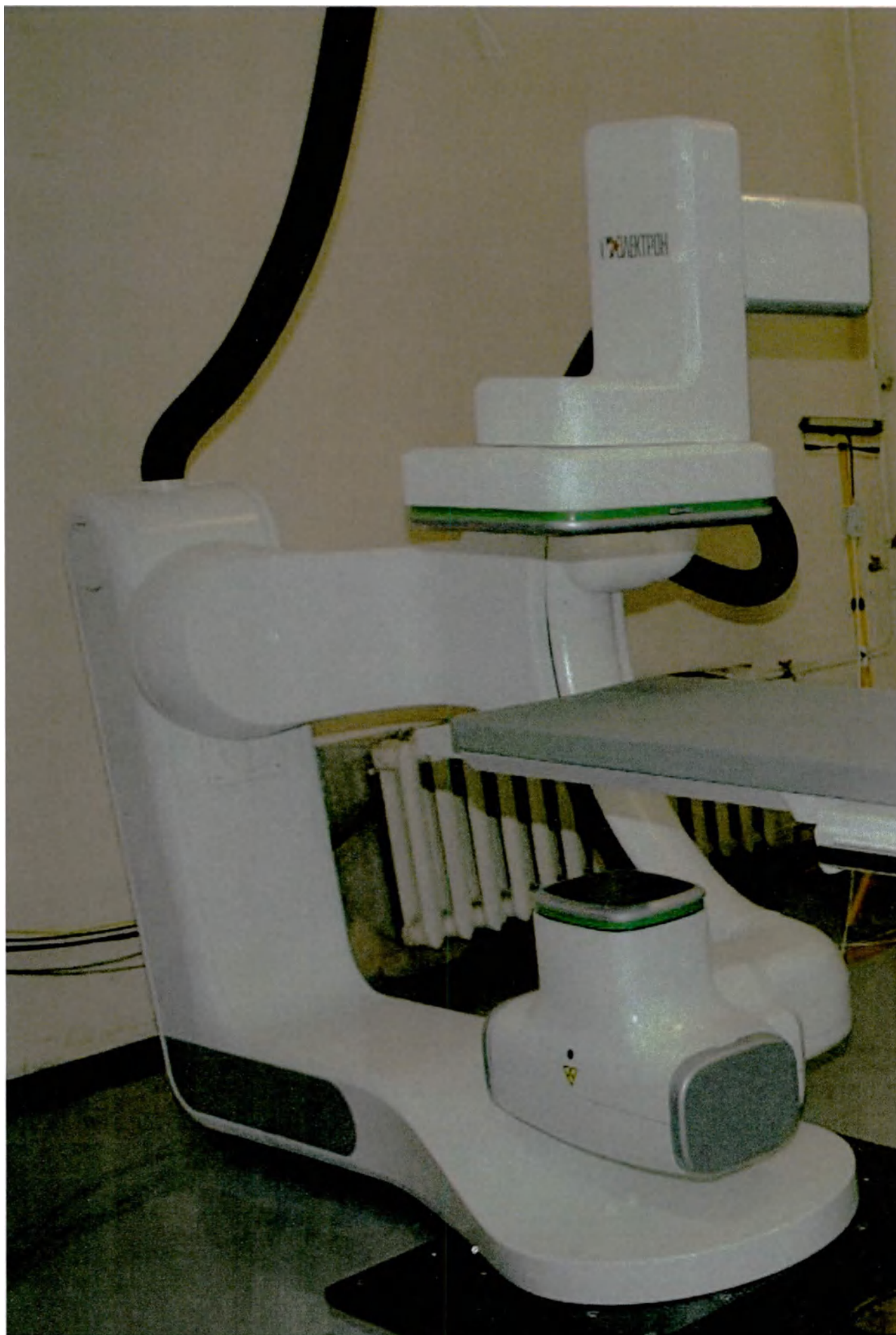
Фотография 7 – Штатив (вариант внешнего вида) по спецификации AKR-00-1000 АО «НИПК «Электрон» в комплектации: Штатив ангиографический С-дуга серии VCV (напольный), Lepu Medical Equipment (Beijing) Co., Ltd
