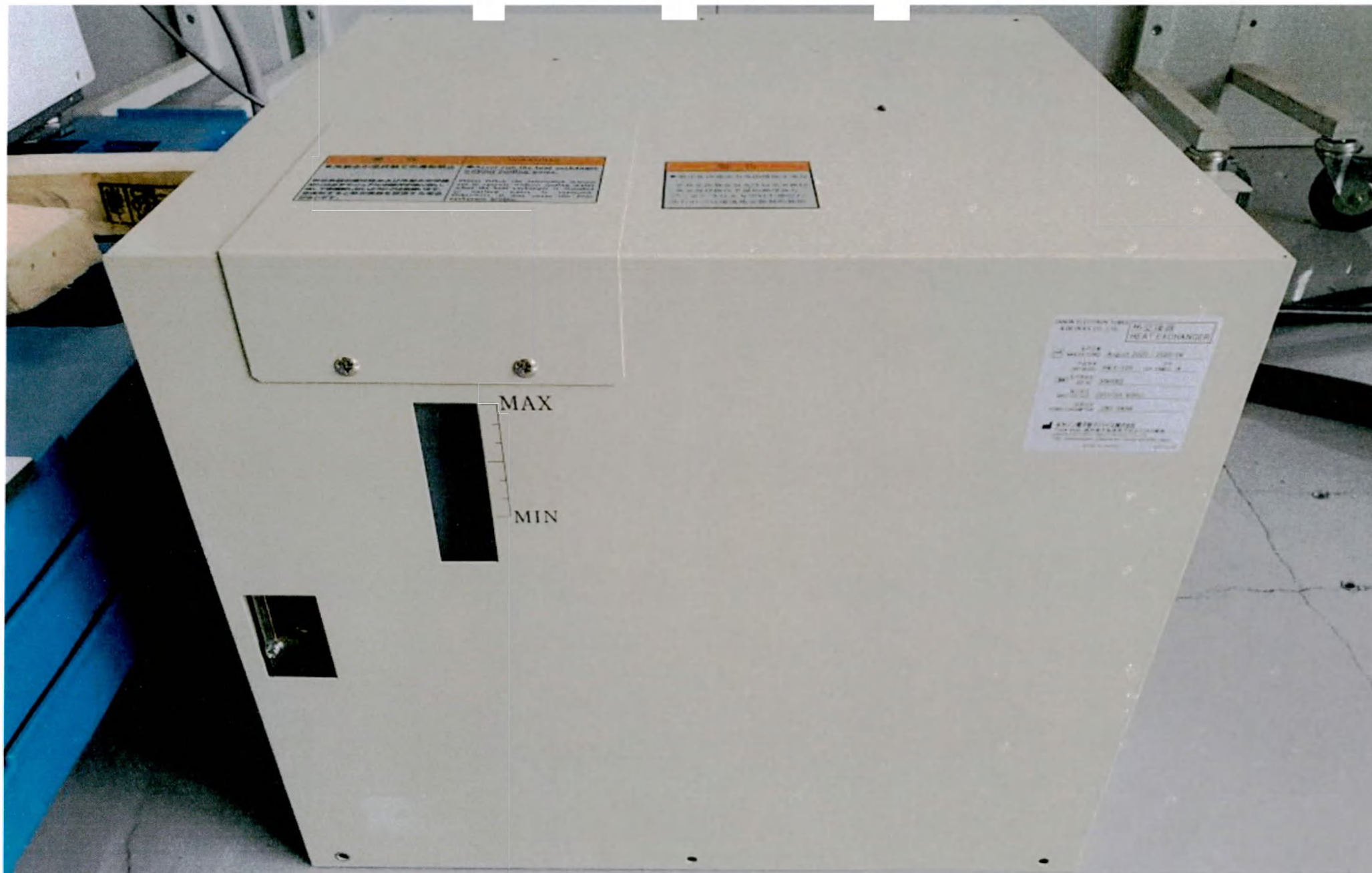
Фотография 26 – Система охлаждения излучателя рентгеновского HEX-125 Canon Electron Tubes & Devices Co., Ltd (в составе излучателя Canon). Вариант внешнего вида
