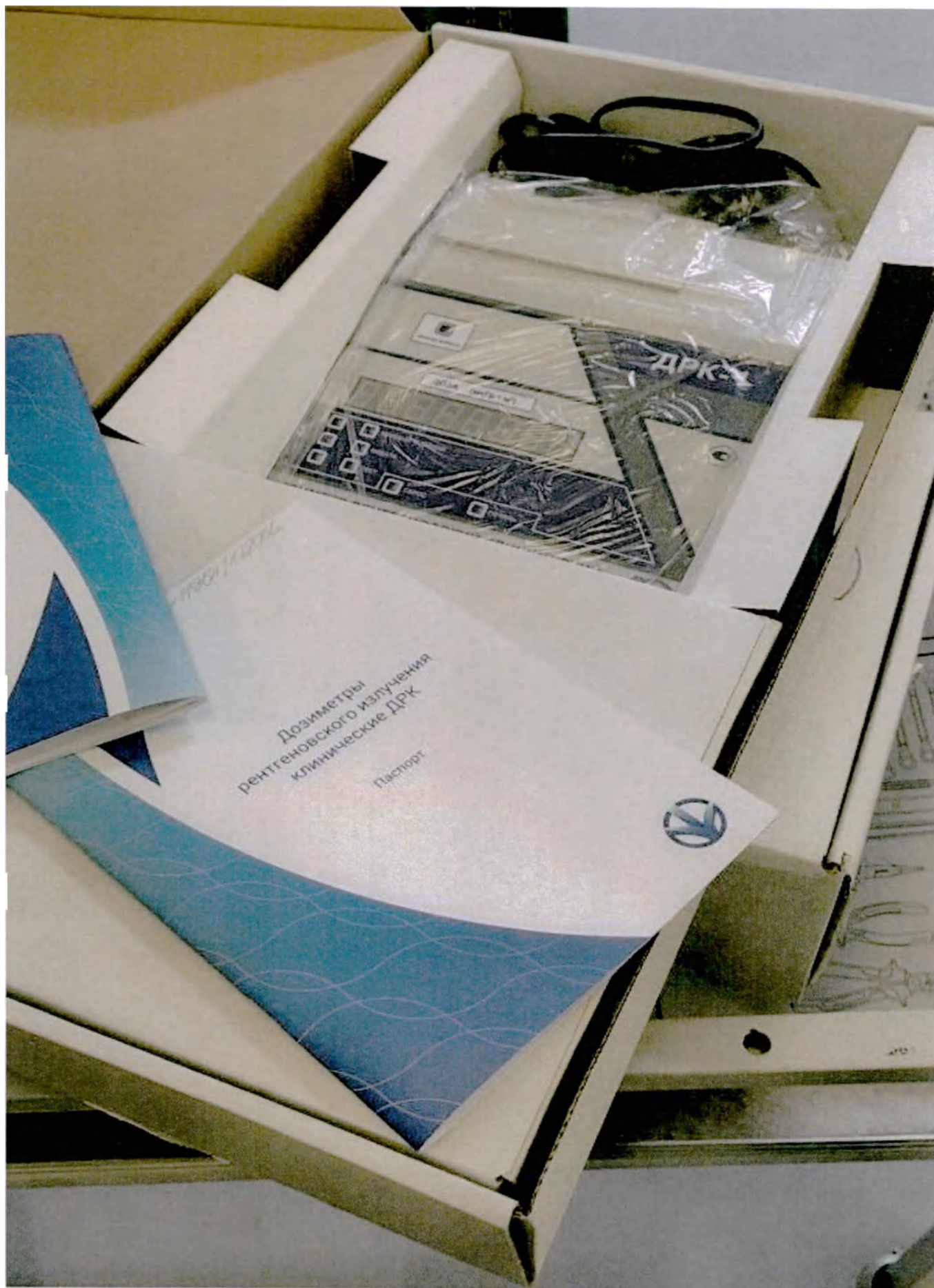
Фотография 157 – Дозиметр ДРК-1 с упаковкой и документацией. Вариант внешнего вида
