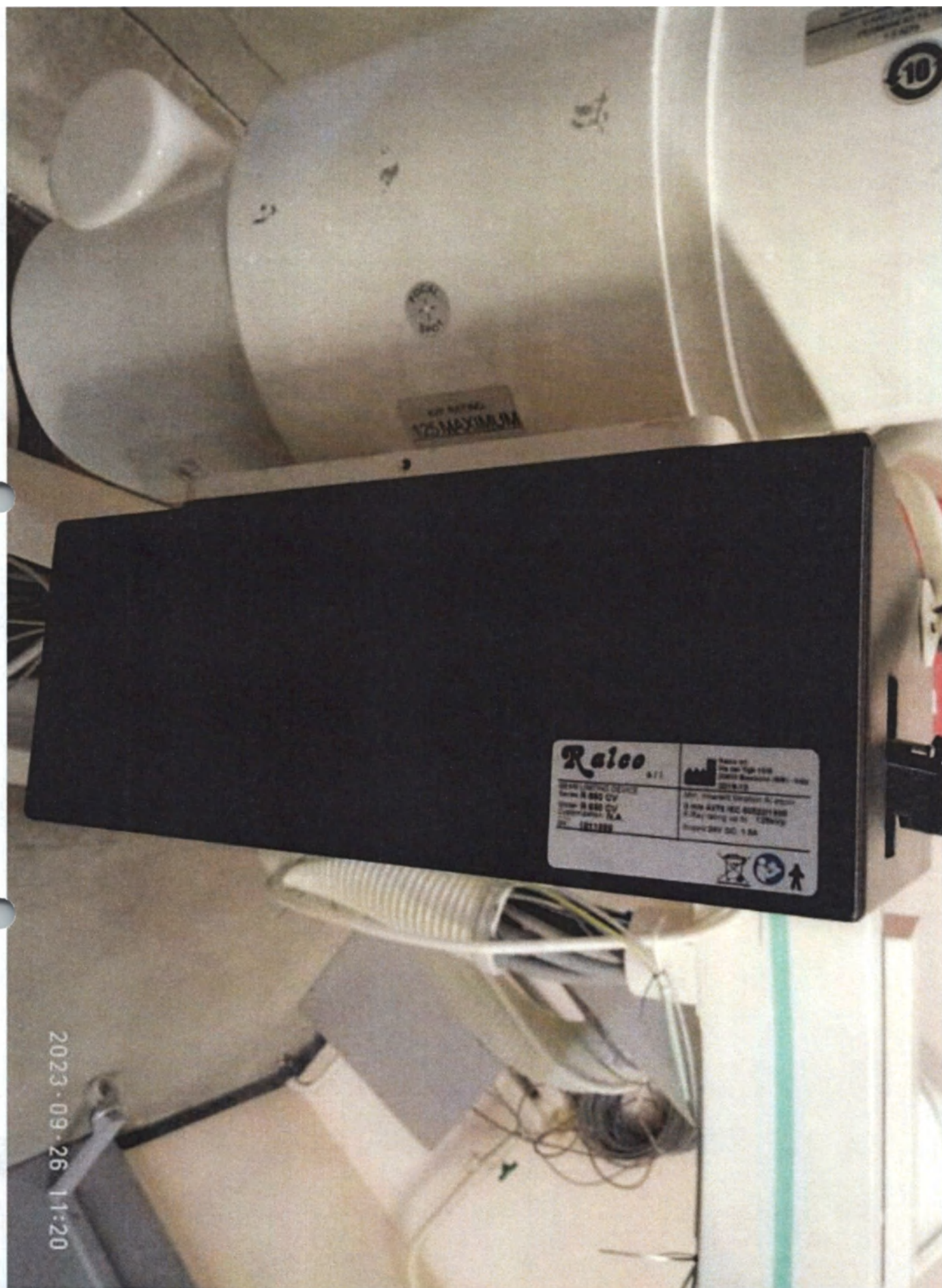
Фотография 43 – Излучатель рентгеновский серии RAD, Varex Imaging и коллиматор (диафрагма) серии R 650CV, RaiCo (при эксплуатации излучатель и коллиматор закрыты кожухом штатива). Вариант внешнего вида
