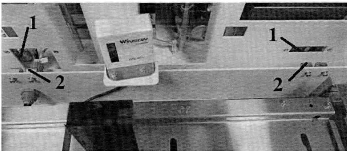
Рис. 23. Фиксация автоподатчика к анализатору (1 – штекер, 2 – гнездо)
