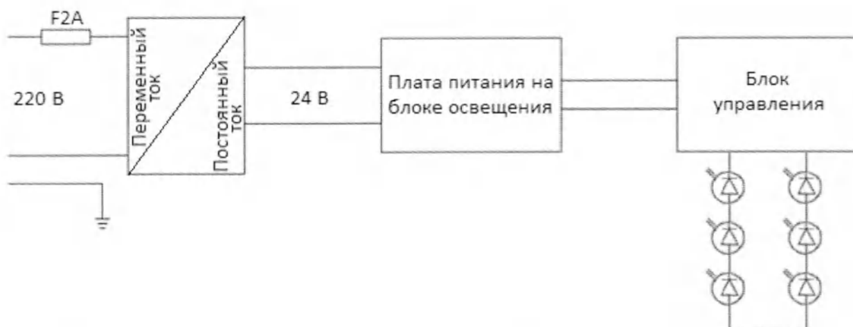
Рис. 11 – Принципиальная электрическая схема светильника исполнения AR-SY320C LED
