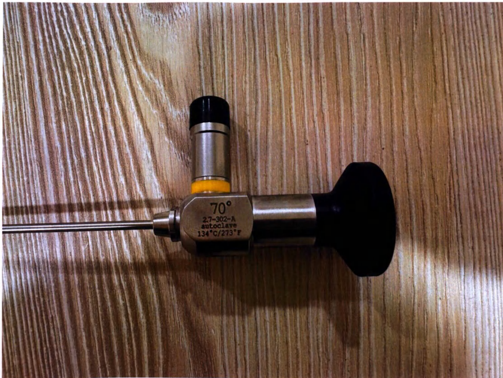
Фото 14. Внешний вид вариантов исполнений: Цистоскоп EndoGlance®, диаметр 4 мм, длина 302 мм, угол 70°, Цистоскоп EndoGlance®, диаметр 2.7 мм, длина 302 мм, угол 70°
