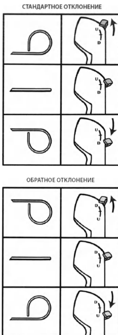
Рисунок 3. Управление изгибом может быть стандартным или обратным в зависимости от используемой модели
