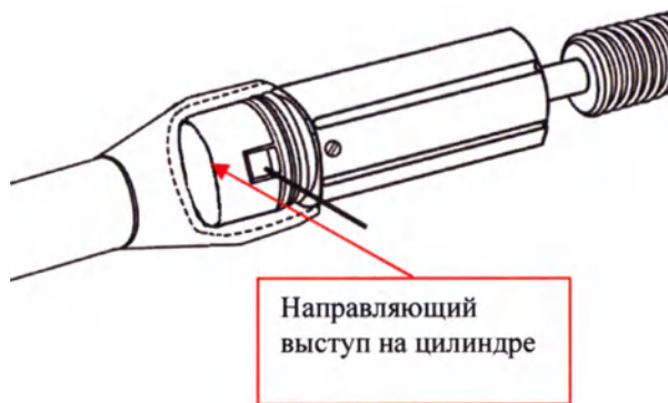
Рис. 3 Направляющий выступ на цилиндре (деталь рукоятки BLIS-R1) (технический рисунок)
