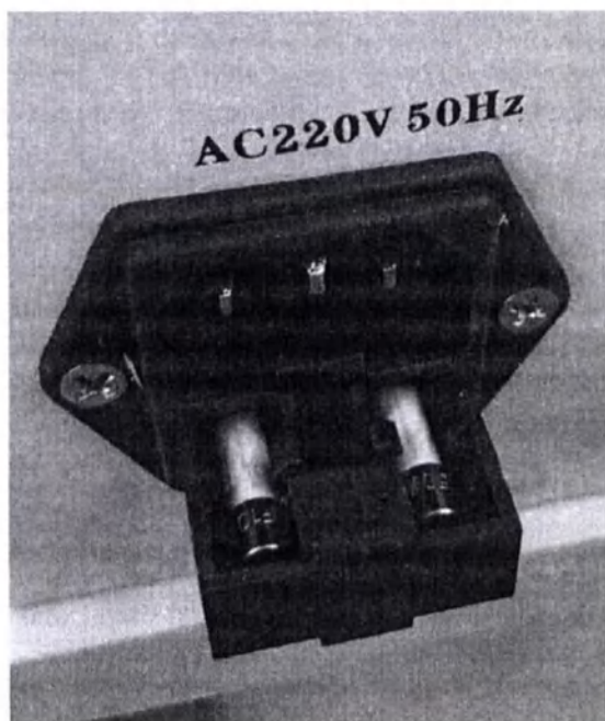
Рис. 11. Разъем для плавкого трубчатого предохранителя
