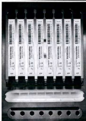
Рис. 8.12. Загрузка заполненного штатива для реагентов в анализатор
