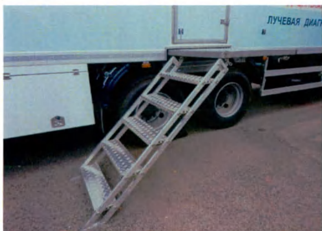
Рисунок 34. Установленный лестничный марш.
