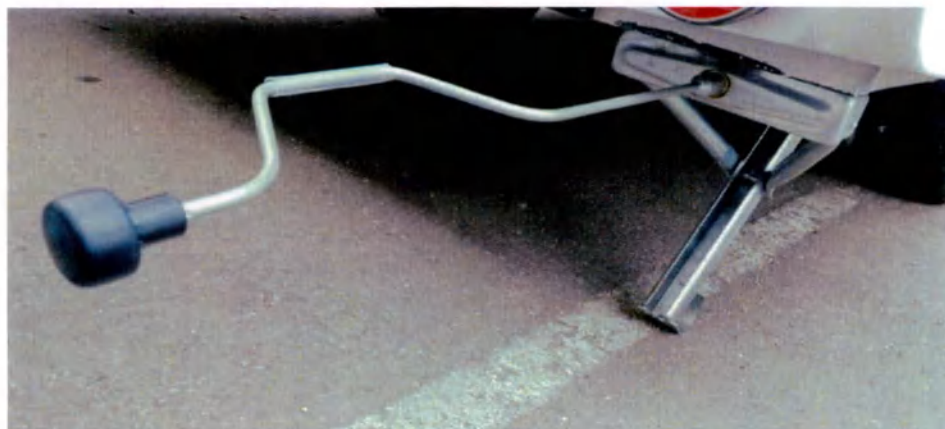
Рисунки 18, 18.1. Установка опор кузова специальным ключом.
