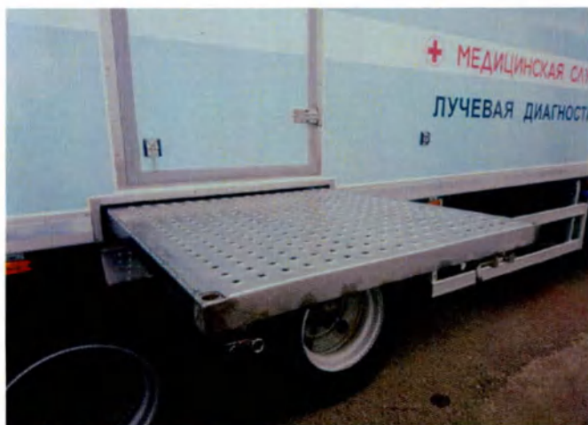
Рисунок 31. Площадка входного трапа.
