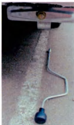
Рисунки 18, 18.1. Установка опор кузова специальным ключом.
