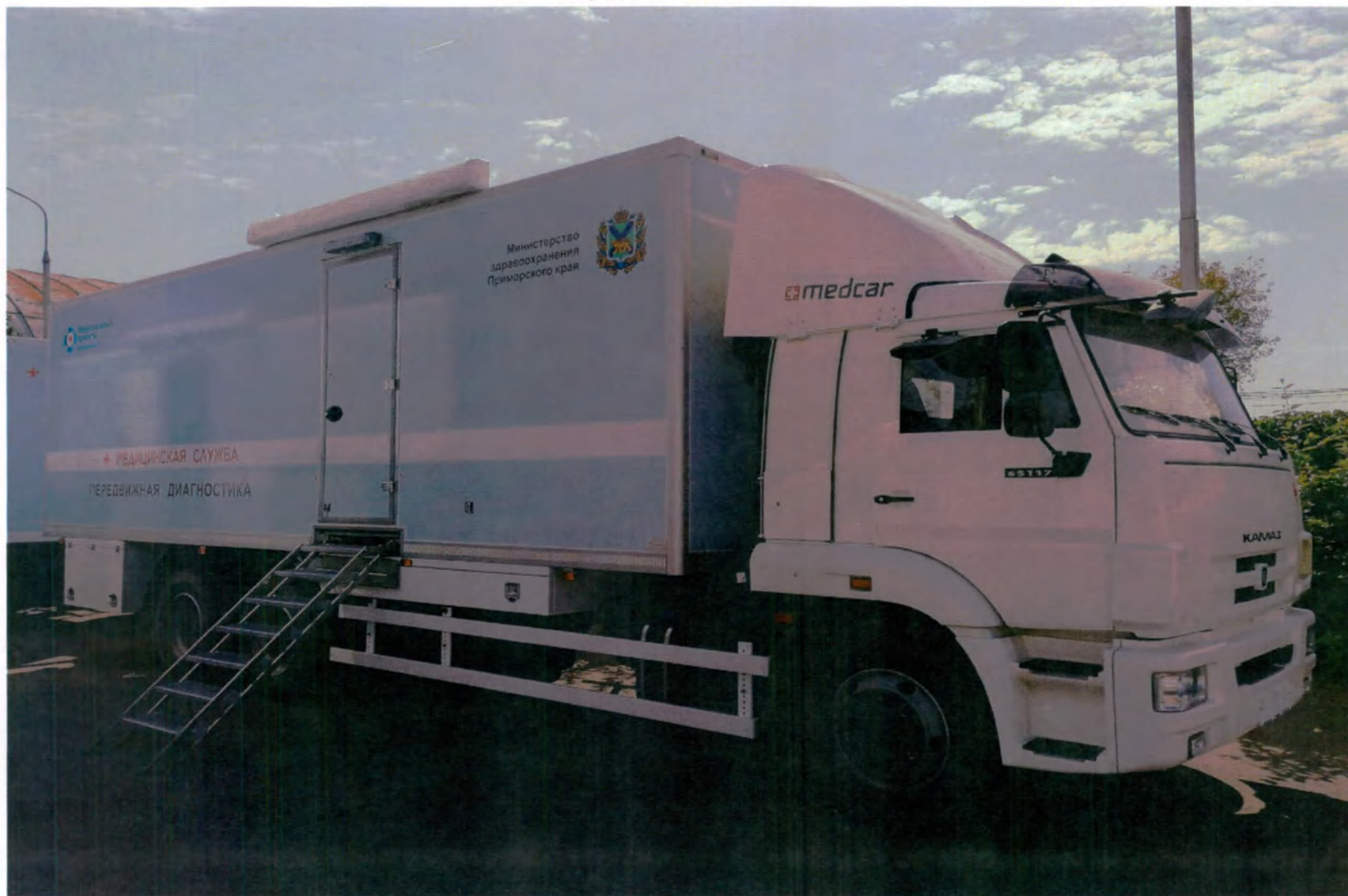
Рисунок 11 Комплекс мобильный. Состоит из кабинетов: «Диагностика», «Лаборатория», «Гинекология» Размещается на базе транспортного средства ПМК-48415»
