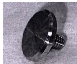
Винт крепления щитка ОВП 381.01.005
