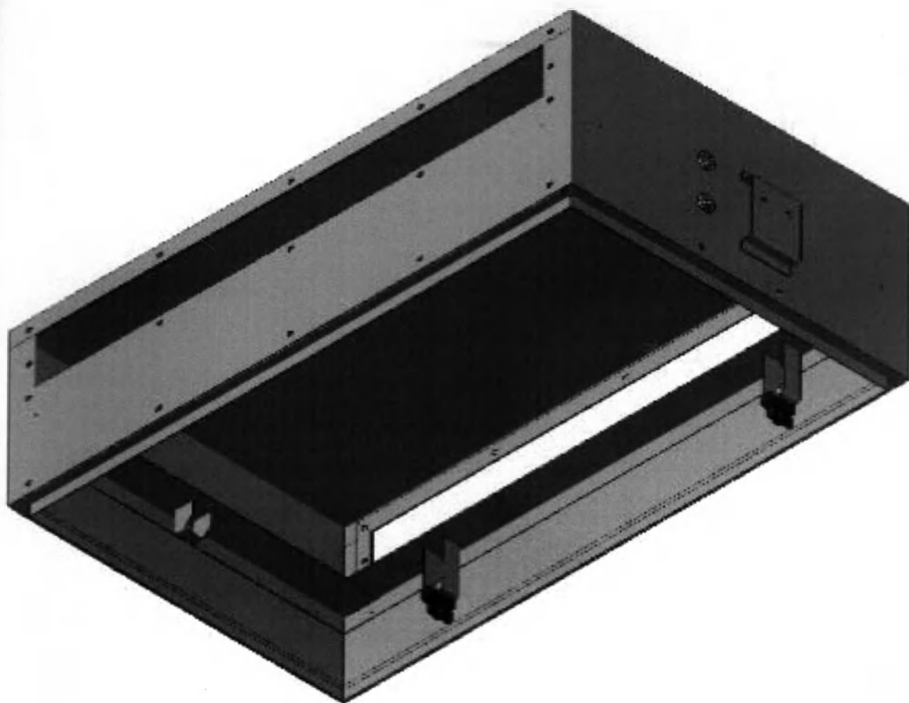
Потолок ламинарный медицинский ЛИТАЭРО по ТУ 32.50.50-007-37247008-2024 в варианте исполнения ЛИТАЭРО 3,6 х 2,6 С. Ячейка ОВП 400.01.03.
