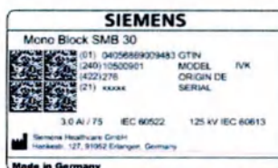
(2) Идентификационная табличка моноблочной трубки
