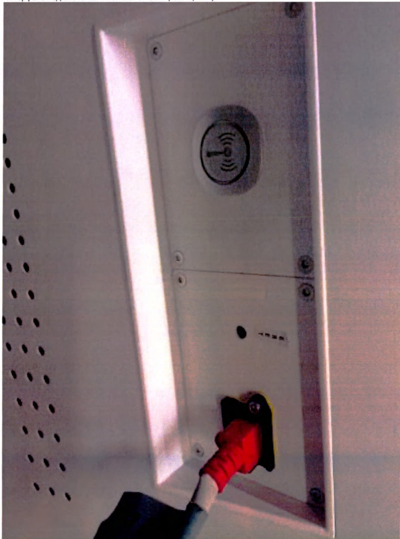
24. Интерфейс подключения к локальной сети (WLAN, LAN).
