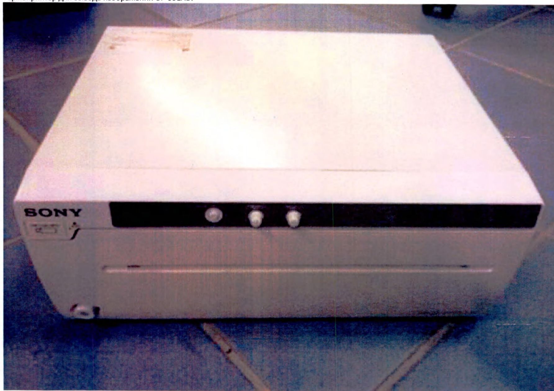
27. Термопринтер для вывода изображений UP-991AD.
