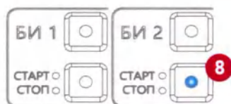
Рисунок 22 – Индикация активного режима «БИ 2» с функцией «АВТОСТОП»
