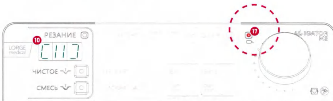
Рисунок 11 – Состояние панели индикации при нарушении контакта в цепи НЭ.
