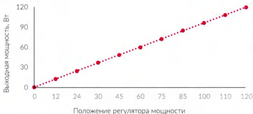
Рисунок 26 – диаграмма зависимости выходной мощности от положения регулятора мощности в режиме «СМЕСЬ» на номинальной нагрузке
