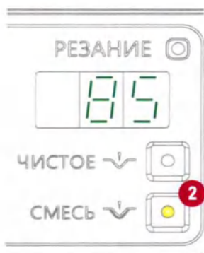
Рисунок 14 – Состояние индикации лицевой панели при выбранном режиме «СМЕСЬ»
