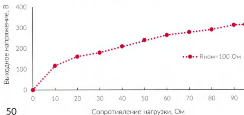
Рисунок 37 – диаграмма зависимости максимального выходного напряжения от положения регулятора мощности в режимах «БИ1»/«БИ2» (в том числе с функцией «АВТОСТАРТ») на номинальной нагрузке
