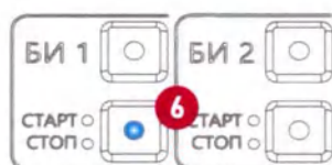
Рисунок 21 – Индикация активного режима «БИ 1» с функцией «АВТОСТОП»
