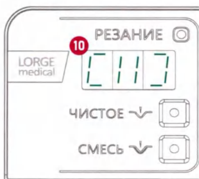
Рисунок 10 – Состояние индикатора мощности режима резание при правильном подключении двухсекционного НЭ
