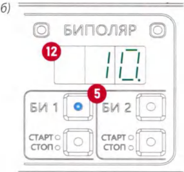
Рисунок 17 – Состояние индикации лицевой панели при выбранном режиме «БИ 1»: а) для исполнения «ALLIGATOR M1»; б) для исполнения «ALLIGATOR M2»;
