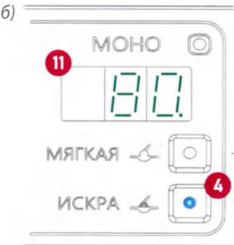
Рисунок 16 – Состояние индикации лицевой панели при выбранном режиме «ИСКРА»
