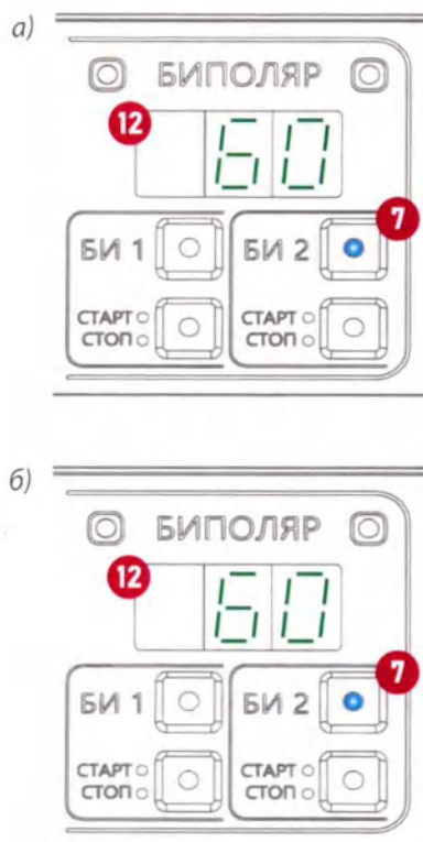
Рисунок 18 – Состояние индикации лицевой панели при выбранном режиме «БИ 2»: а) для исполнения «ALLIGATOR M1»; б) для исполнения «ALLIGATOR M2»
