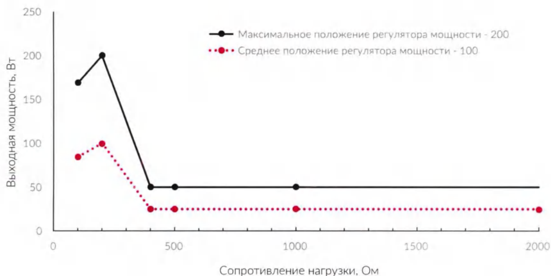
Рисунок 44 – диаграммы зависимости выходной мощности от сопротивления нагрузки в режиме «МЯГКАЯ»
