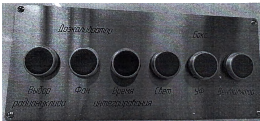
Рисунок 2б – Панель управления дозкалибратором и боксом
