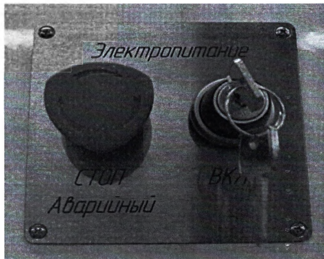
Рисунок 3 – Маркировка выключателя электропитания и кнопки аварийного обесточивания бокса
