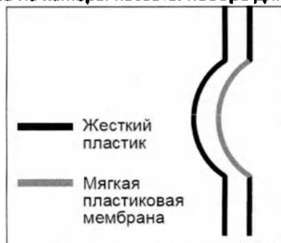
Рисунок 10. Поступление раствора из камеры кассеты набора для АПД.
