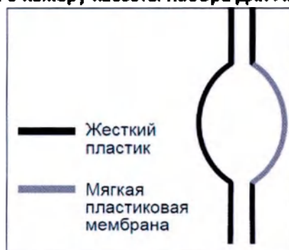
Рисунок 9. Поступление раствора в камеру кассеты набора для АД.
