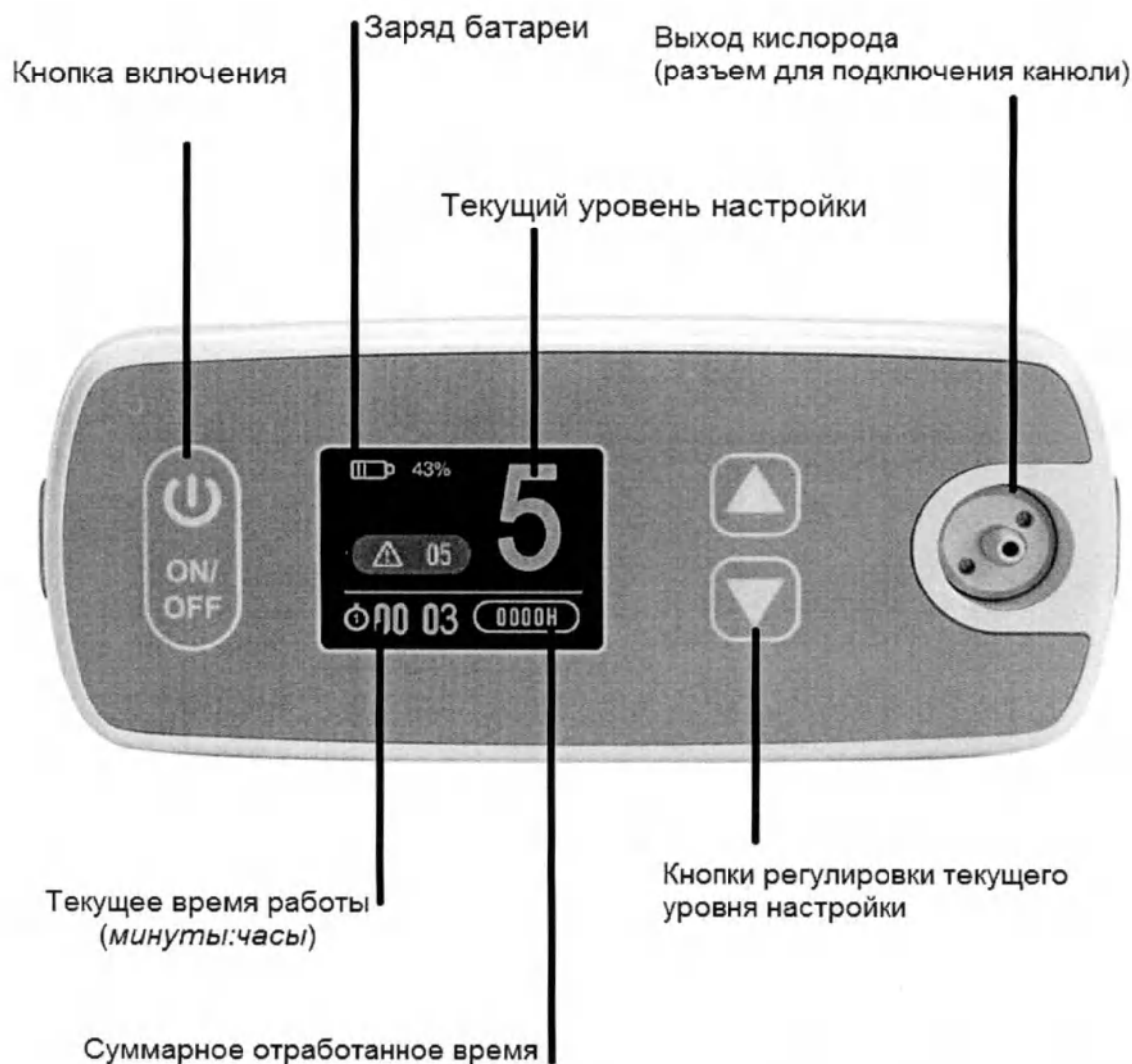
Рисунок 2 – панель управления «Концентратор медицинский кислородный портативный Longfian Jay-1000P»
