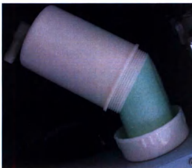
Рис.25. Третий фильтр (Фильтр тонкой очистки). Концентратор медицинский кислородный Longfian Jay-10D
