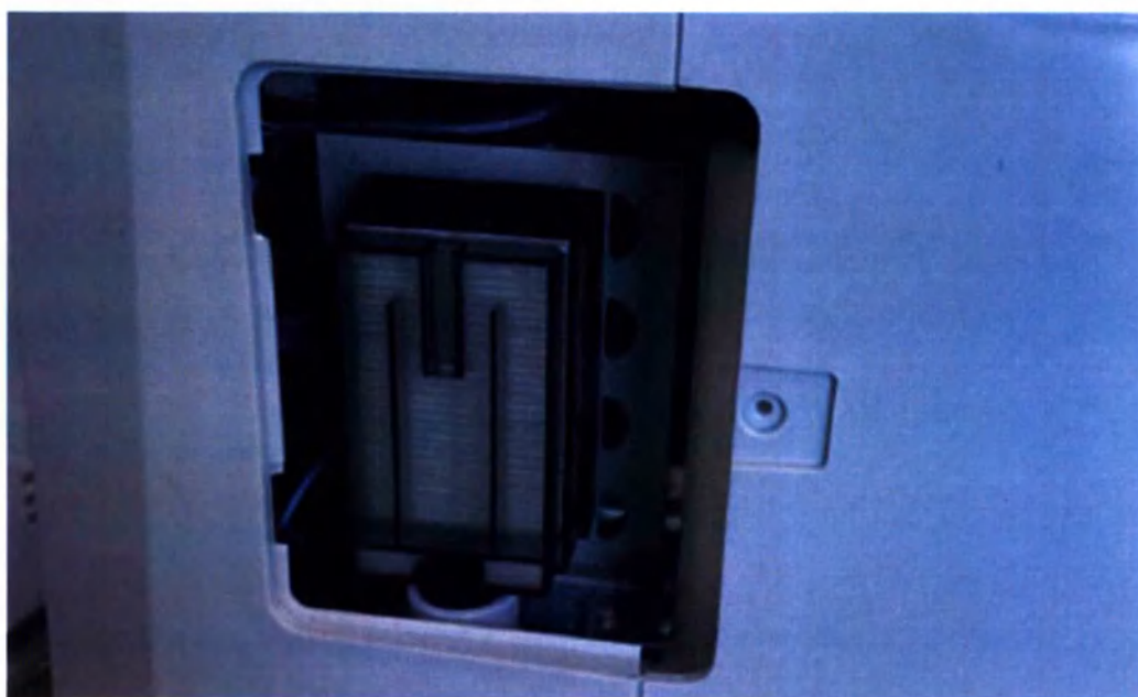
Рис.16. Фильтр тонкой очистки. Концентратор медицинский кислородный Longfian Jay-10FW-D
