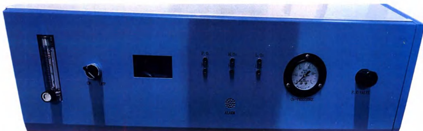
Рис.23. Панель управления. Концентратор медицинский кислородный Longfian JAY-10D
