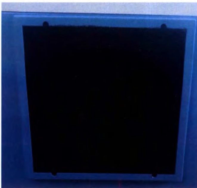
Рис.19. Первый фильтр (Фильтр грубой очистки). Концентратор медицинский кислородный Longfian Jay-10S
