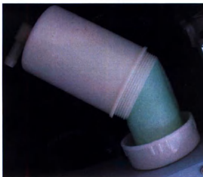
Рис.21. Третий фильтр (Фильтр тонкой очистки). Концентратор медицинский кислородный Longfian Jay-10S
