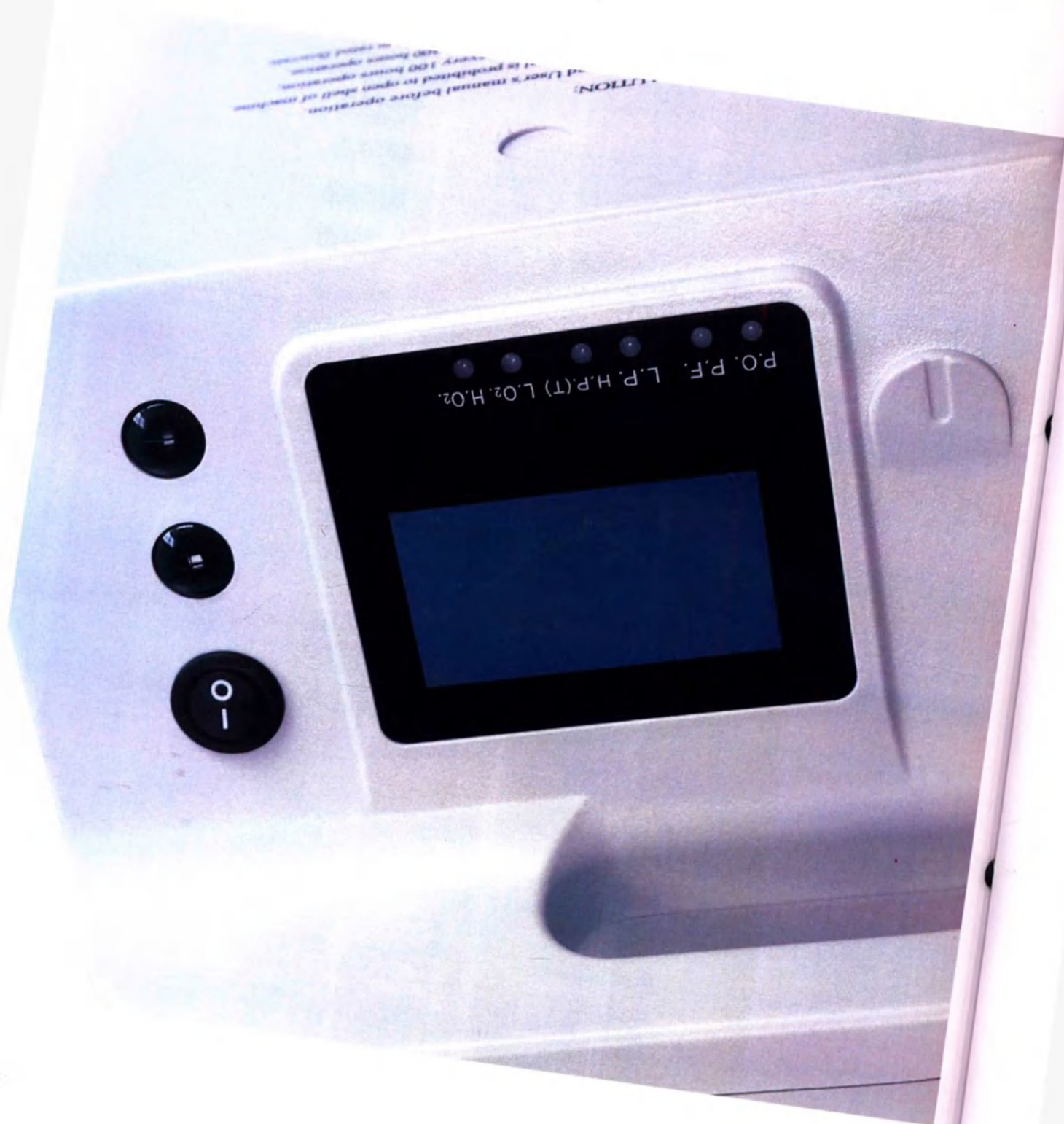
Рис.6. Панель управления. Концентратор медицинский кислородный Longfan Jay-5BW
