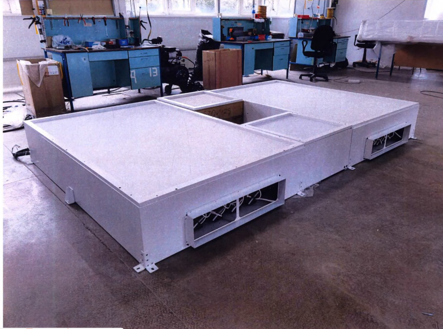
Обеззараживатель - очиститель фотокаталитический воздуха "Аэролайф" с ламинарными воздушными распределителями, модель ЛАМ 3002
