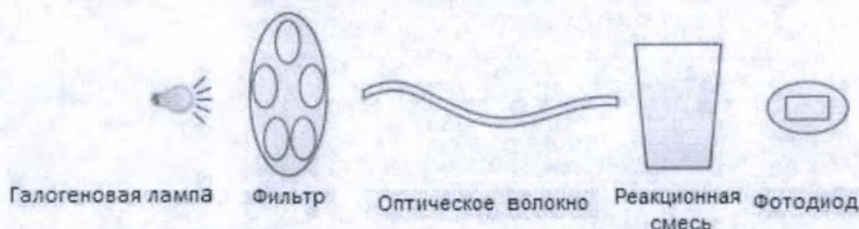
Рисунок 2-3. Принципиальная схема светового пути для хромогенного и иммунотурбидиметрического метода
