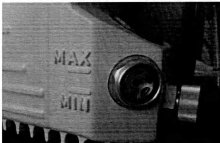
Рисунок 4.15. Уровень масла в вакуумном насосе.
