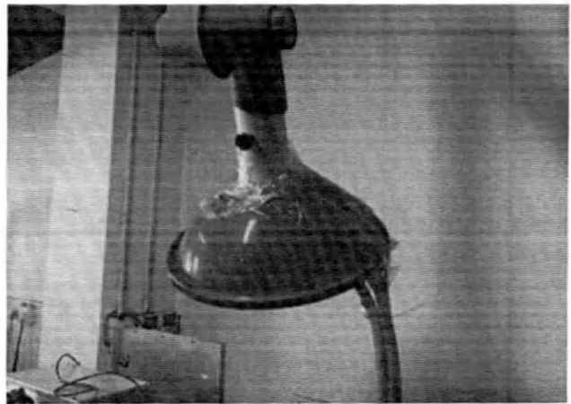
Рисунок 4.17. Схема подключения выхлопной трубы вакуумного насоса.
