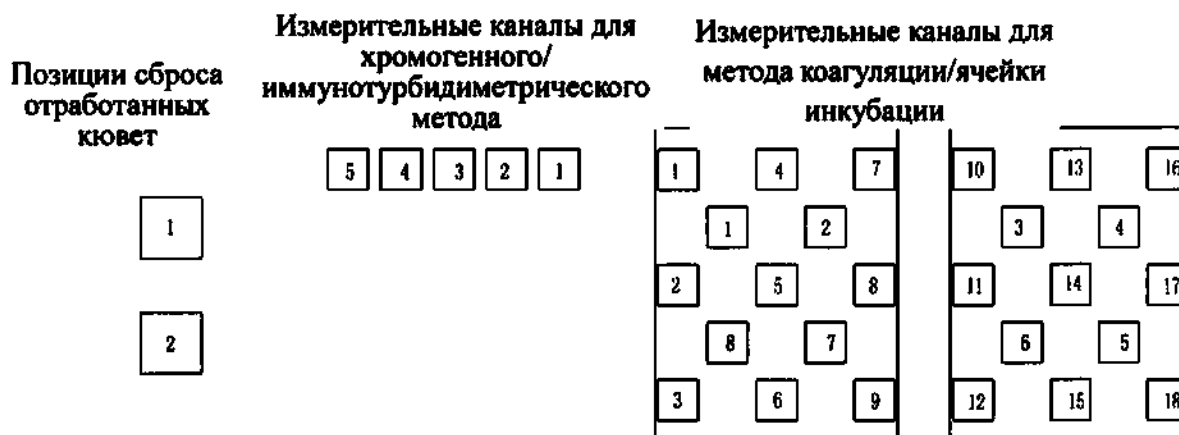
Рисунок 1-2. Вид сверху измерительных позиций блока измерения.
