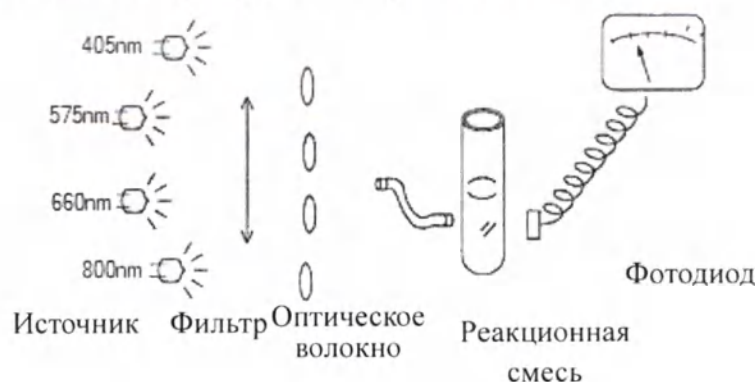
Рисунок 2-3. Схема светового потока для хромогенного и иммунотурбидиметрического метода
