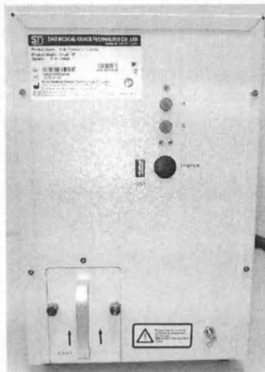
Рис. 11. Блок управления системы инъекционной с установленной аккумуляторной батареей.
