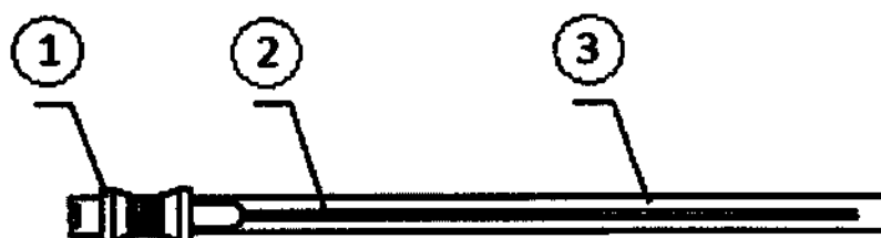
1. Втулка трубки; 2. Трубка иглы; 3. Защитная трубка.
