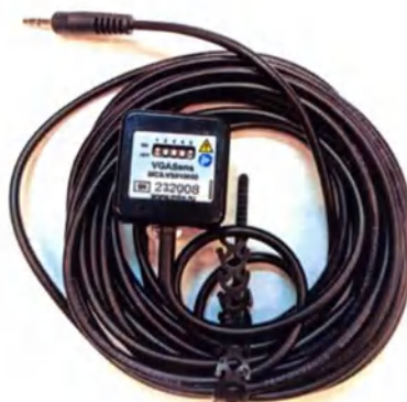
Рис.8 Датчик синхронизации фотометрический VGAsens
