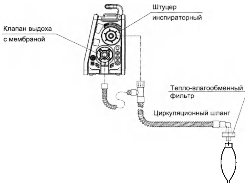
Рисунок 3.19 – Схема сборки коаксиального дыхательного контура
