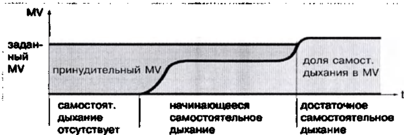
Рисунок 2 Пр. 1.11 – Графическое представление автоматического перехода с принудительной вентиляции на вспомогательную
