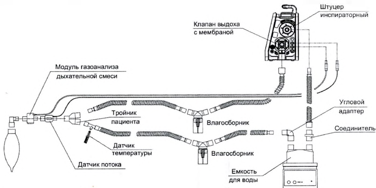
Рисунок 3.11 – Схема сборки детского/ неонатального контура с датчиком потока с двумя влагосборниками с увлажнителем VN-2000 или ТЕВЛАР (без сервоконтроля)
