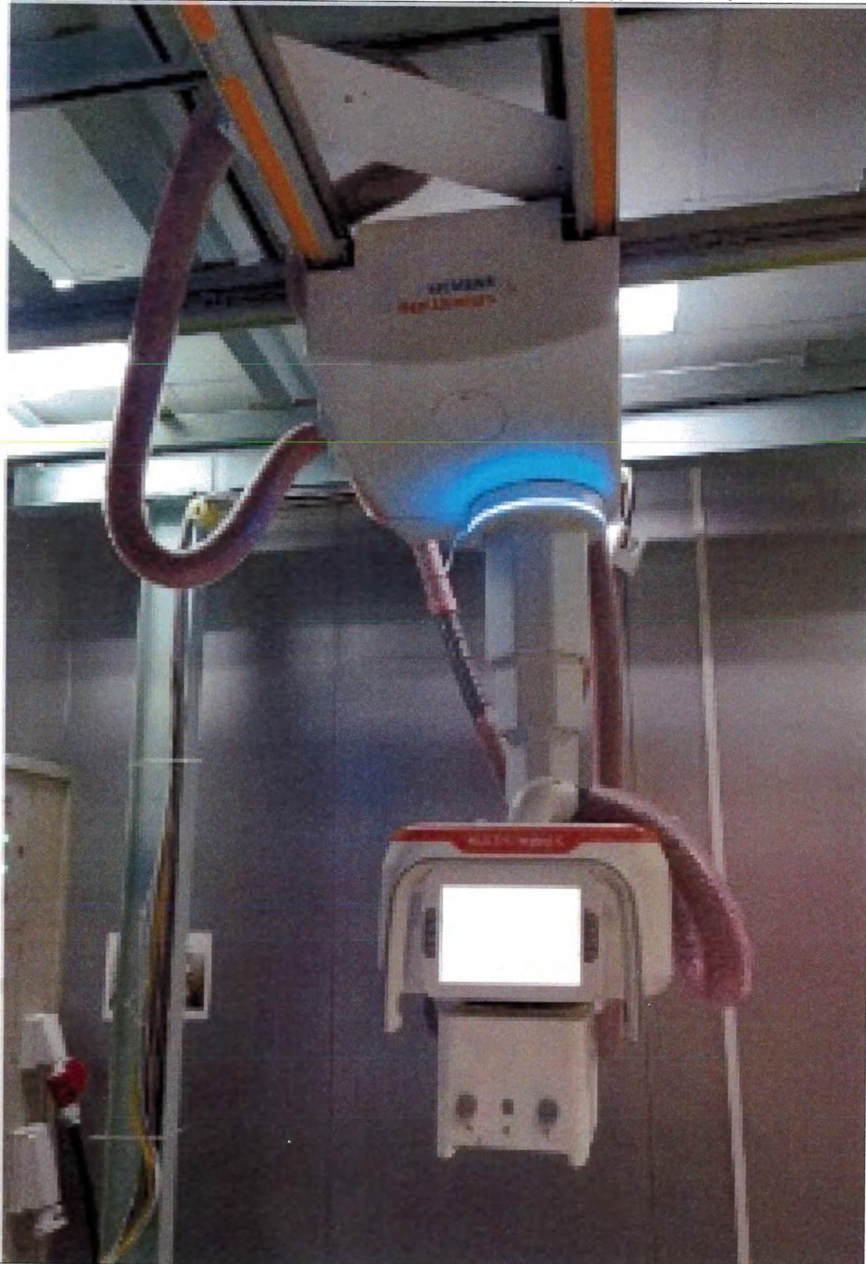
1. Потолочный штатив MULTIX Impact C с панелью управления, рентгеновским излучателем, сенсорным интерфейсом пользователя и коллиматором, вариант исполнения: - стандартный, -с моторизованным наклоном. (Изображение распространяется на все варианты исполнения)
