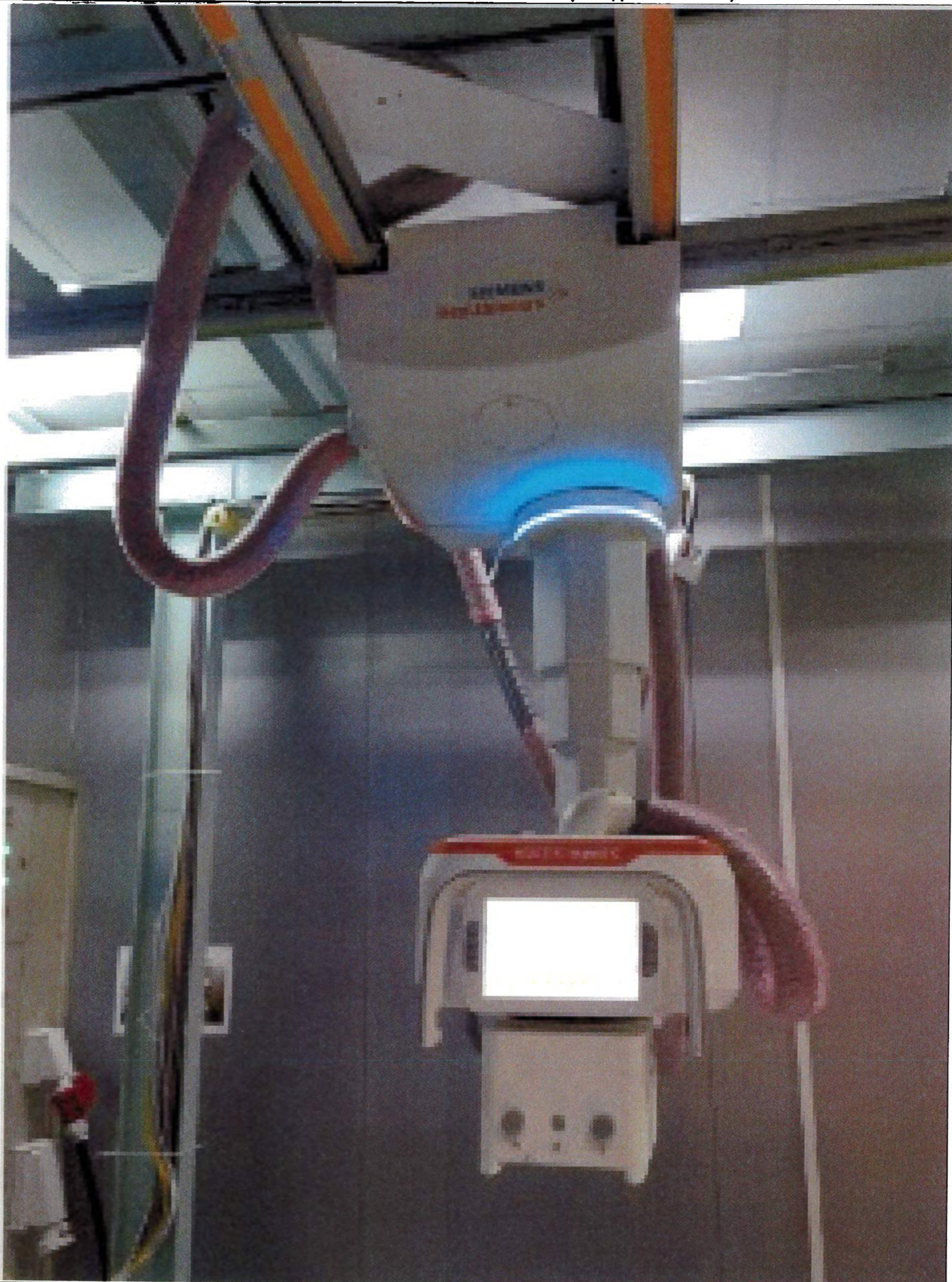
1.1. Потолочный штатив MULTIX Impact C с панелью управления, рентгеновским излучателем, сенсорным интерфейсом пользователя и коллиматором, вариант исполнения: - стандартный, - с моторизованным наклоном. (Изображение распространяется на все варианты исполнения)
