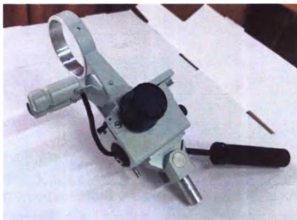
Кронштейн оптической головки с механизмом точной фокусировки, осветителем и зелёным фильтром
