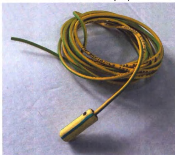
Кабель заземления с коннектором
