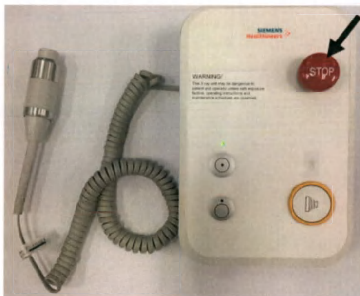
На пульте ВКЛ/ВЫКЛ генератора
