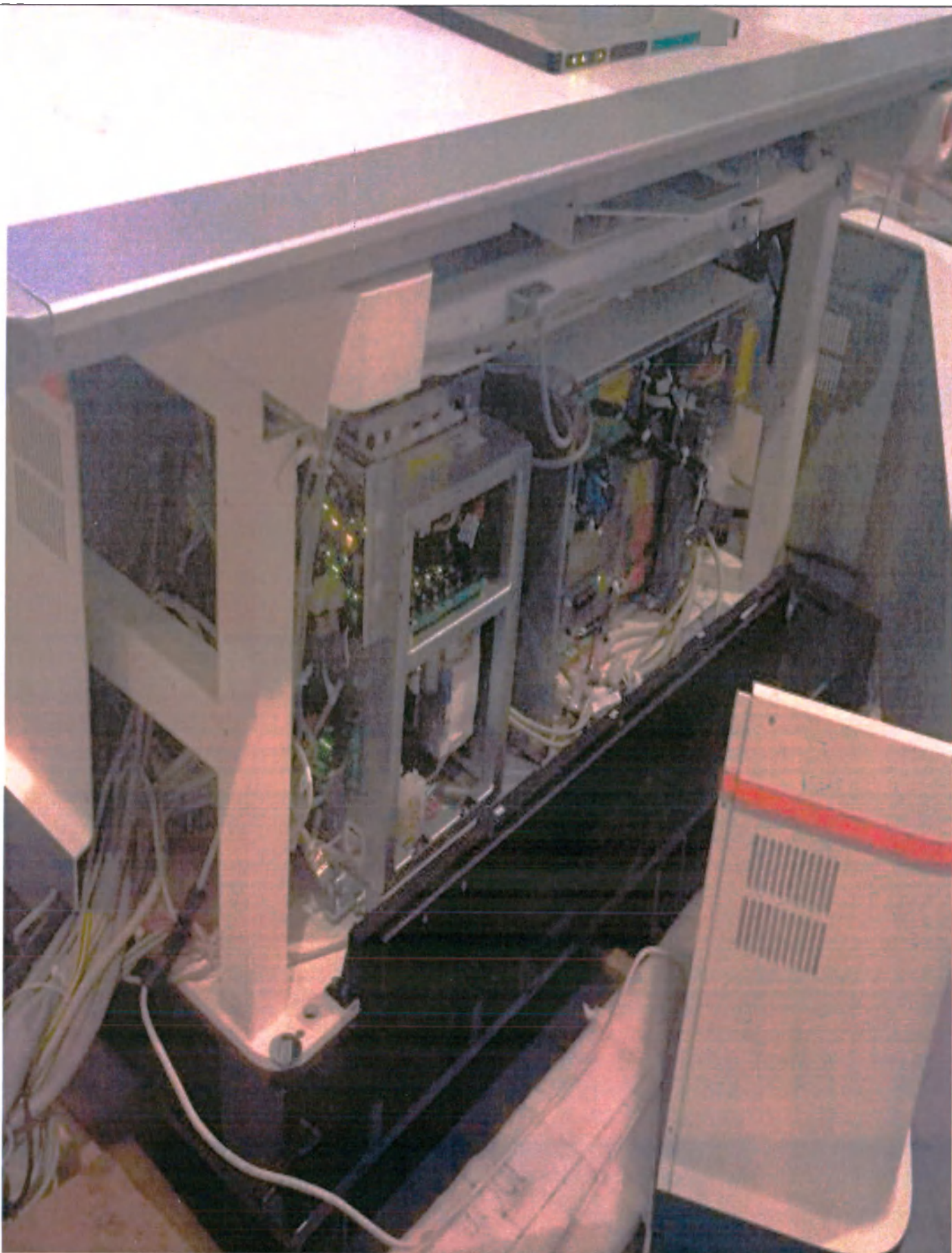
8.1 Генератор рентгеновский, варианты исполнения: встроенный; внешний Высоковольтный генератор для фиксированного стола
