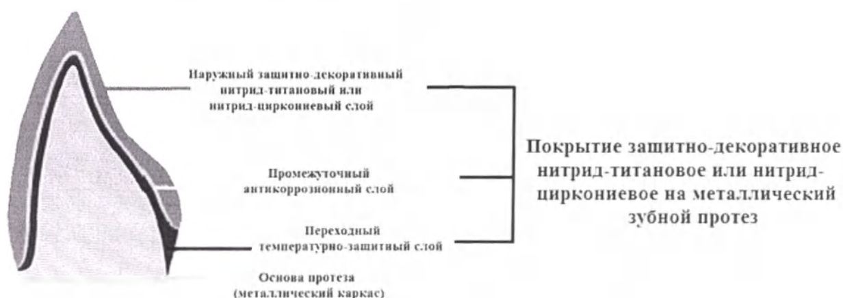
Рисунок 3 – Изображение состава многослойного Покрытия
