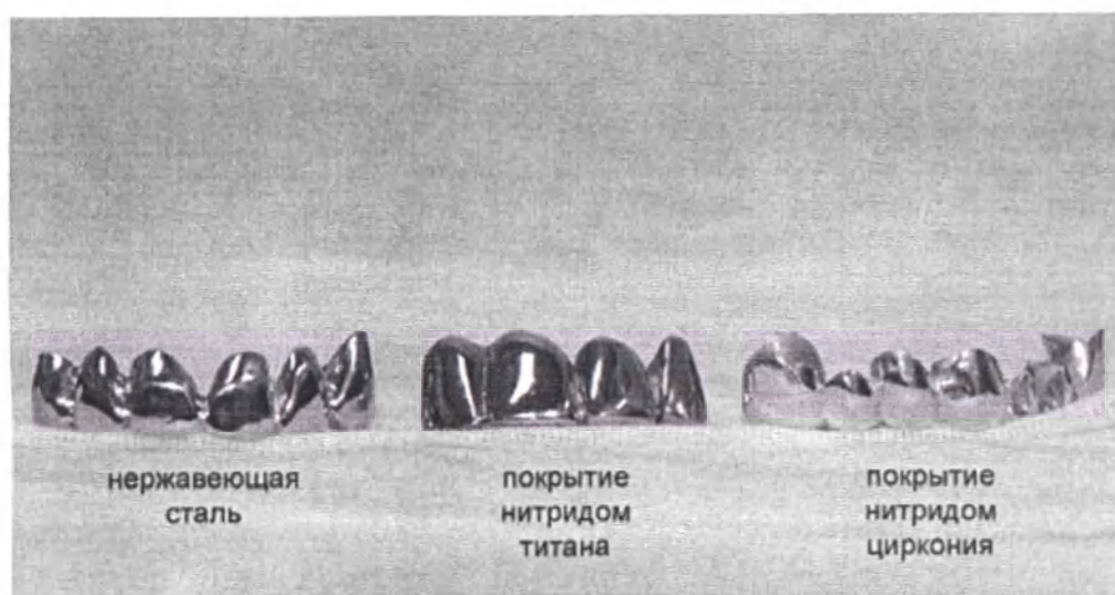
Рисунок 1 – Покрытие защитно-декоративное нитрид-титановое и нитрид-циркониевое на металлические зубные протезы
