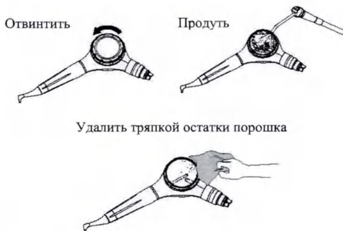
Рис. 9. Схематичное изображение процесса очистки от порошка
