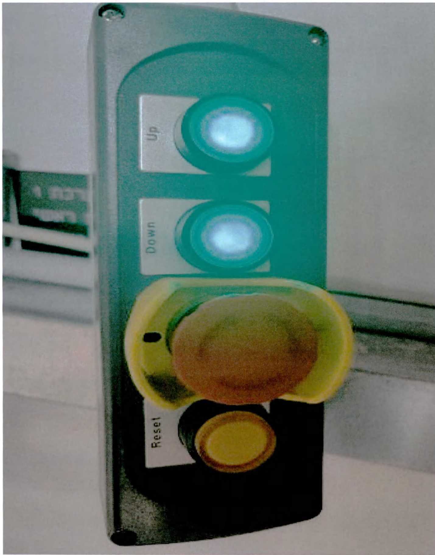
2.4.8. Пульт для ручного управления механизмом подъёма и опускания рентгеновских детекторов
