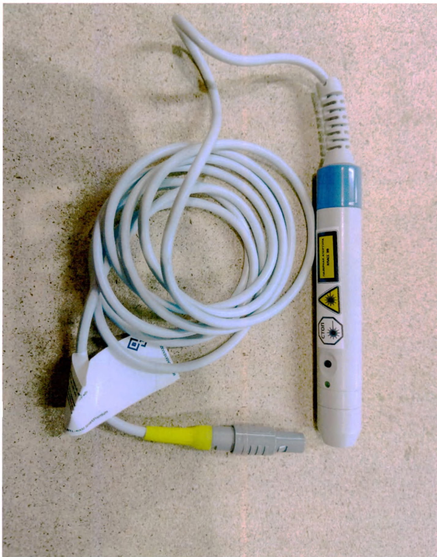
13. Зонд лазерный, инфракрасный, 830 нм, 300 мВт
