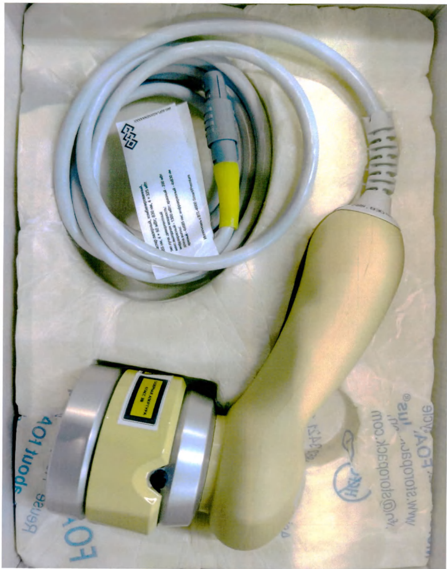
19. Кластер лазерный, комбинированный, 685 нм, 4 × 50 мВт; 830 нм, 4 × 325 мВт
