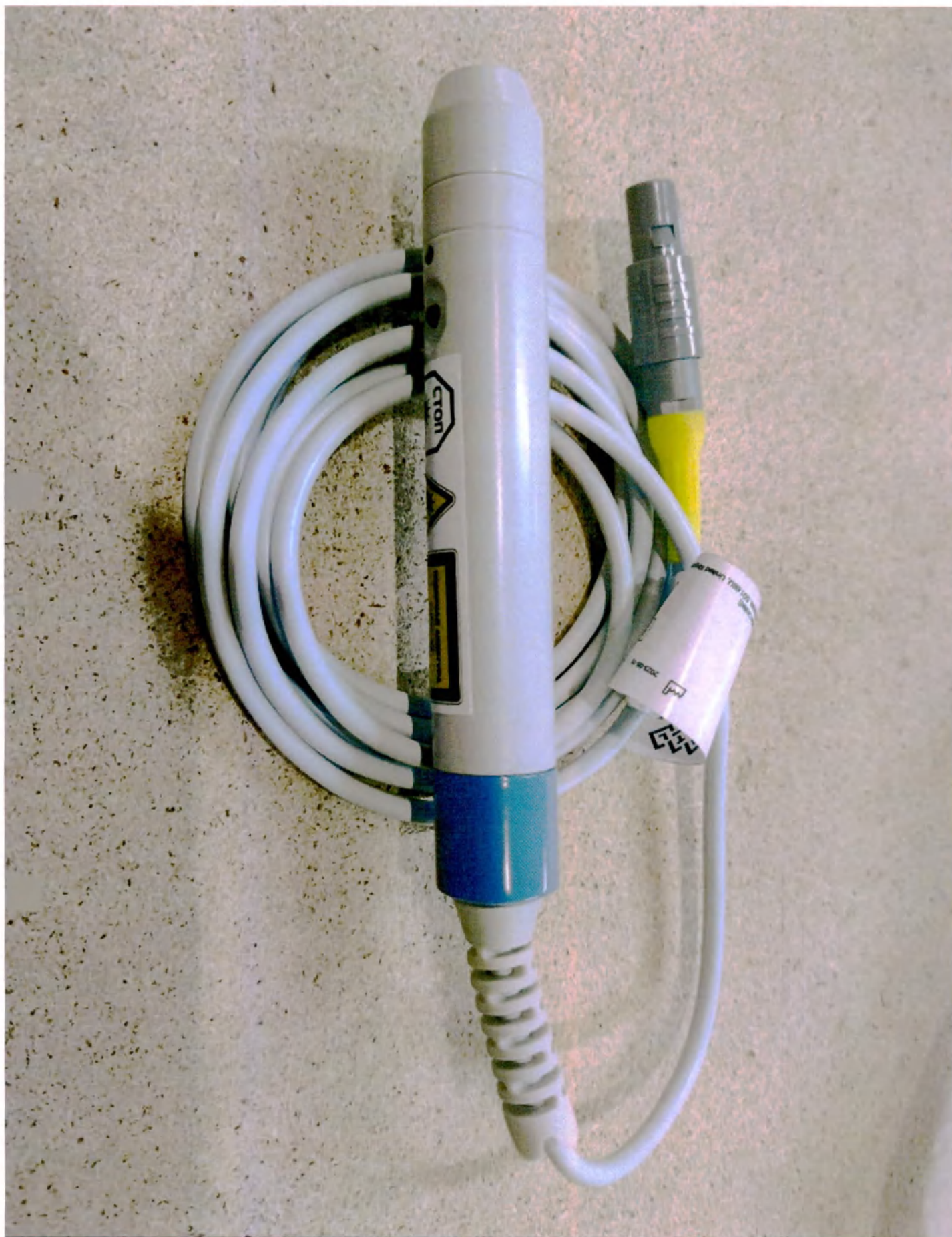
10. Зонд лазерный, инфракрасный, 830 нм, 50 мВт
