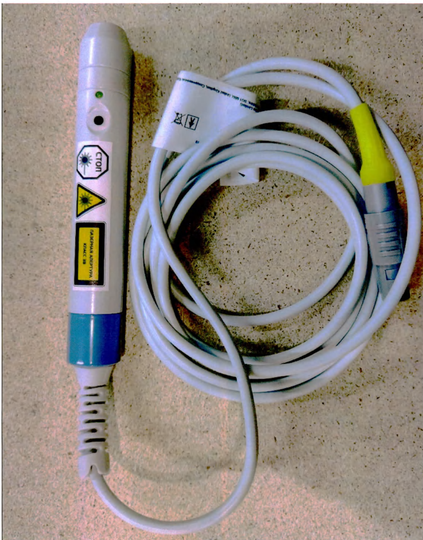
11. Зонд лазерный, инфракрасный, 830 нм, 100 мВт
