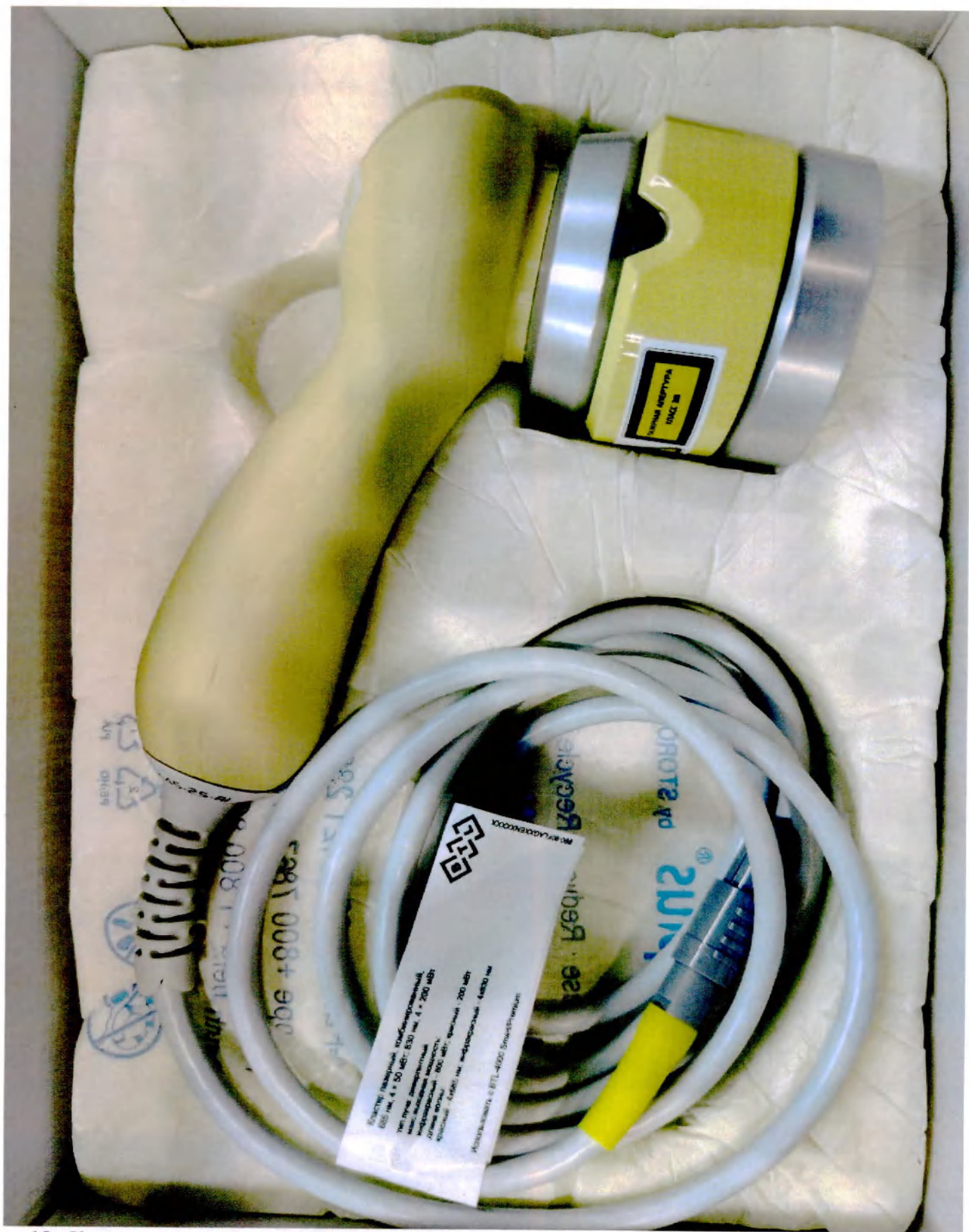
18. Кластер лазерный, комбинированный, 685 нм, 4 × 50 мВт; 830 нм, 4 × 200 мВт
