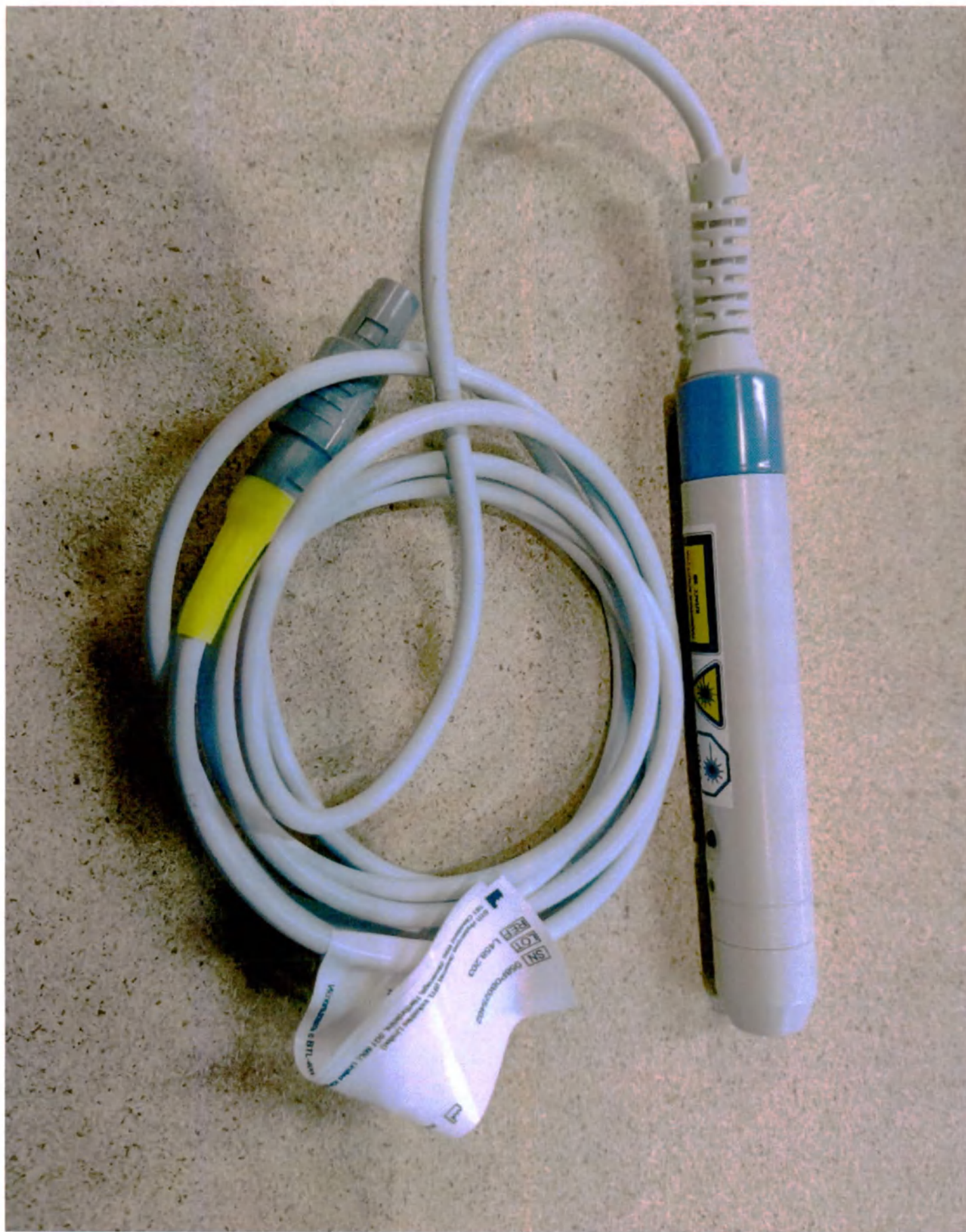
12. Зонд лазерный, инфракрасный, 830 нм, 200 мВт
