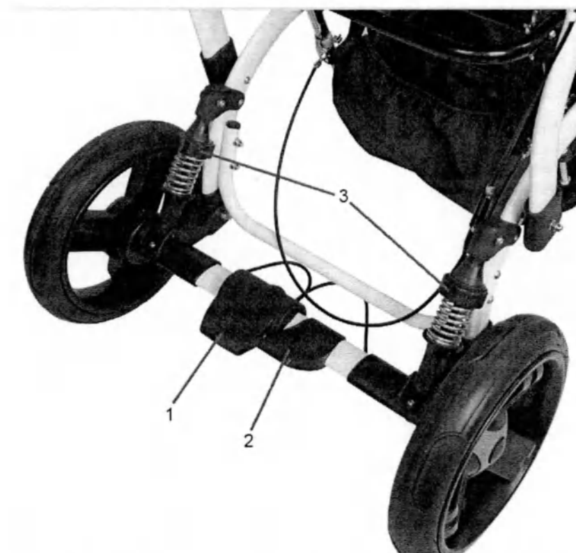
Рис. 19 – Конструктивные элементы подвески задних колес кресла-коляски исполнения Эвита, где:
