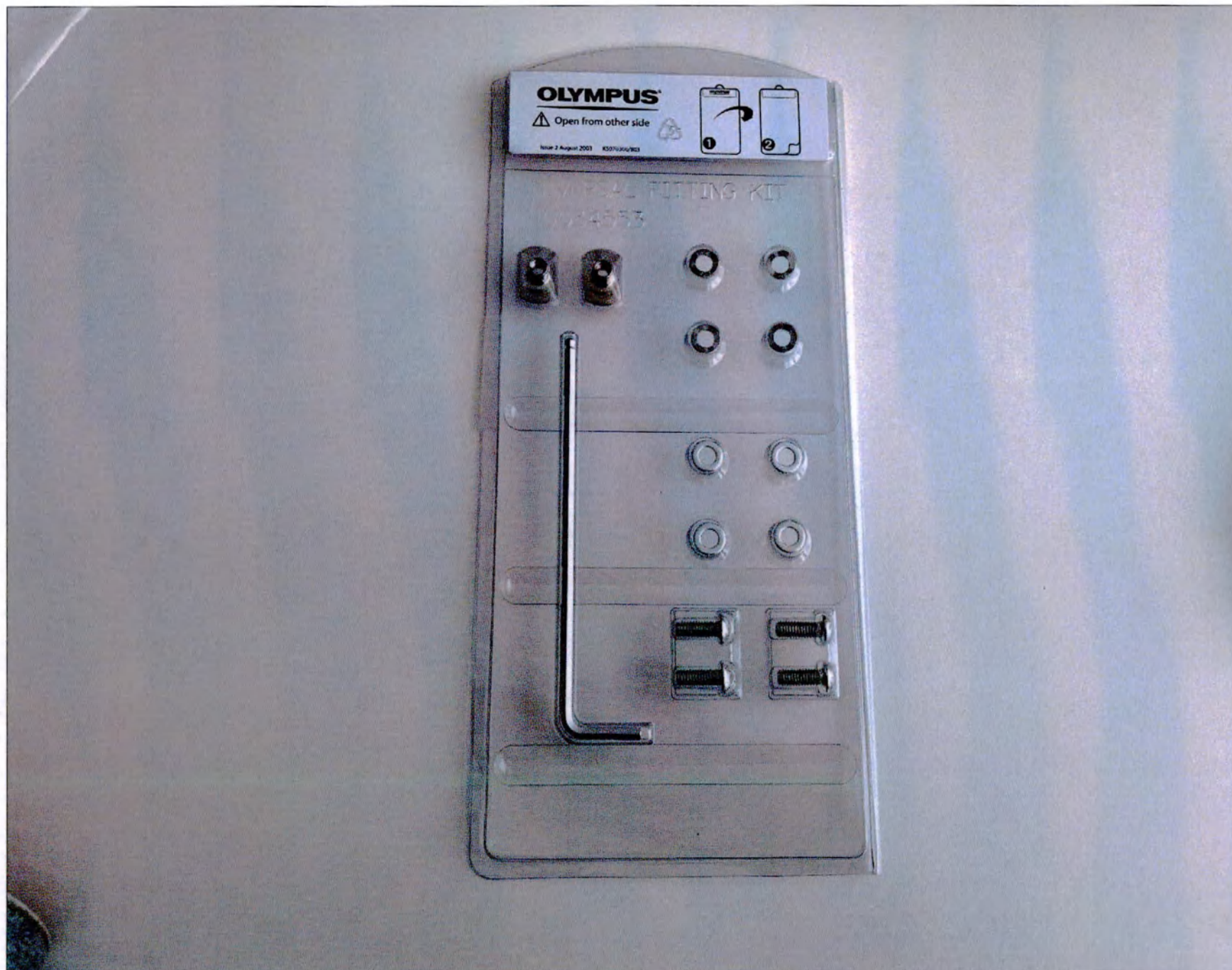
Рис. 12. Универсальный крепежный комплект в блистерной упаковке, в составе: Винт М6 – 4 шт, Гофрированная шайба М6 – 4 шт, Плоская шайба М6 – 4 шт, К-гайка М6 – 2 шт, Шестигранный ключ 4 мм – 1 шт
