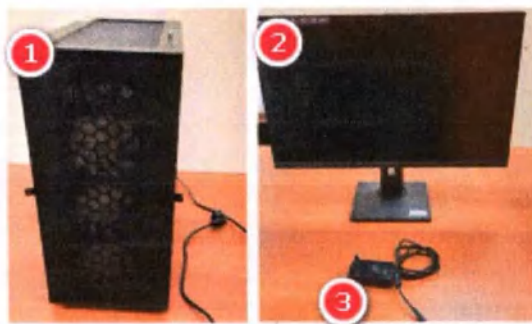
Персональный компьютер в составе: системный блок (1) и монитор (2) в комплекте с адаптером питания (3)
