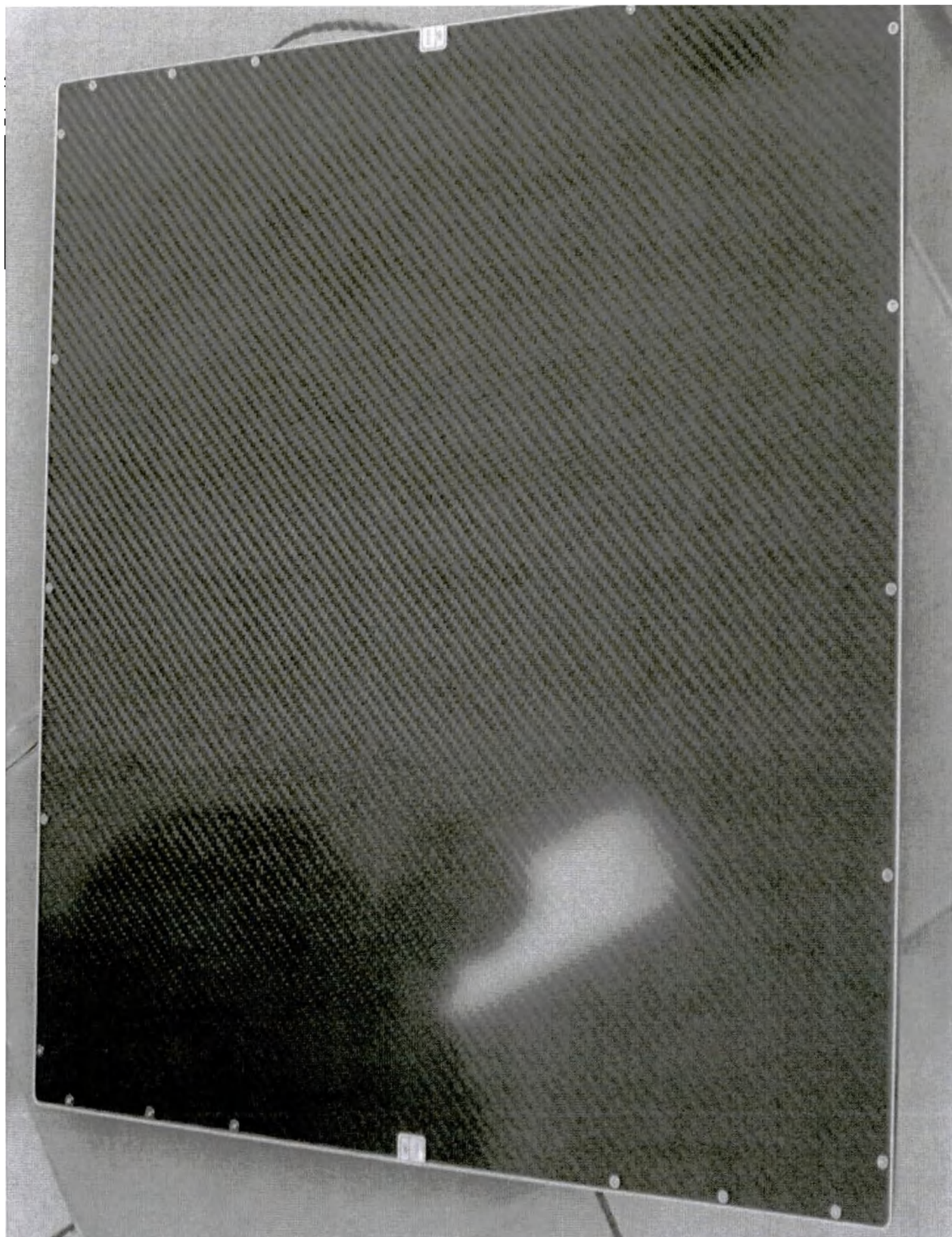
Рис. 23. Приемник рентгеновский цифровой плоскочелный VIVIX-S, модель FXRD-1717SA;
