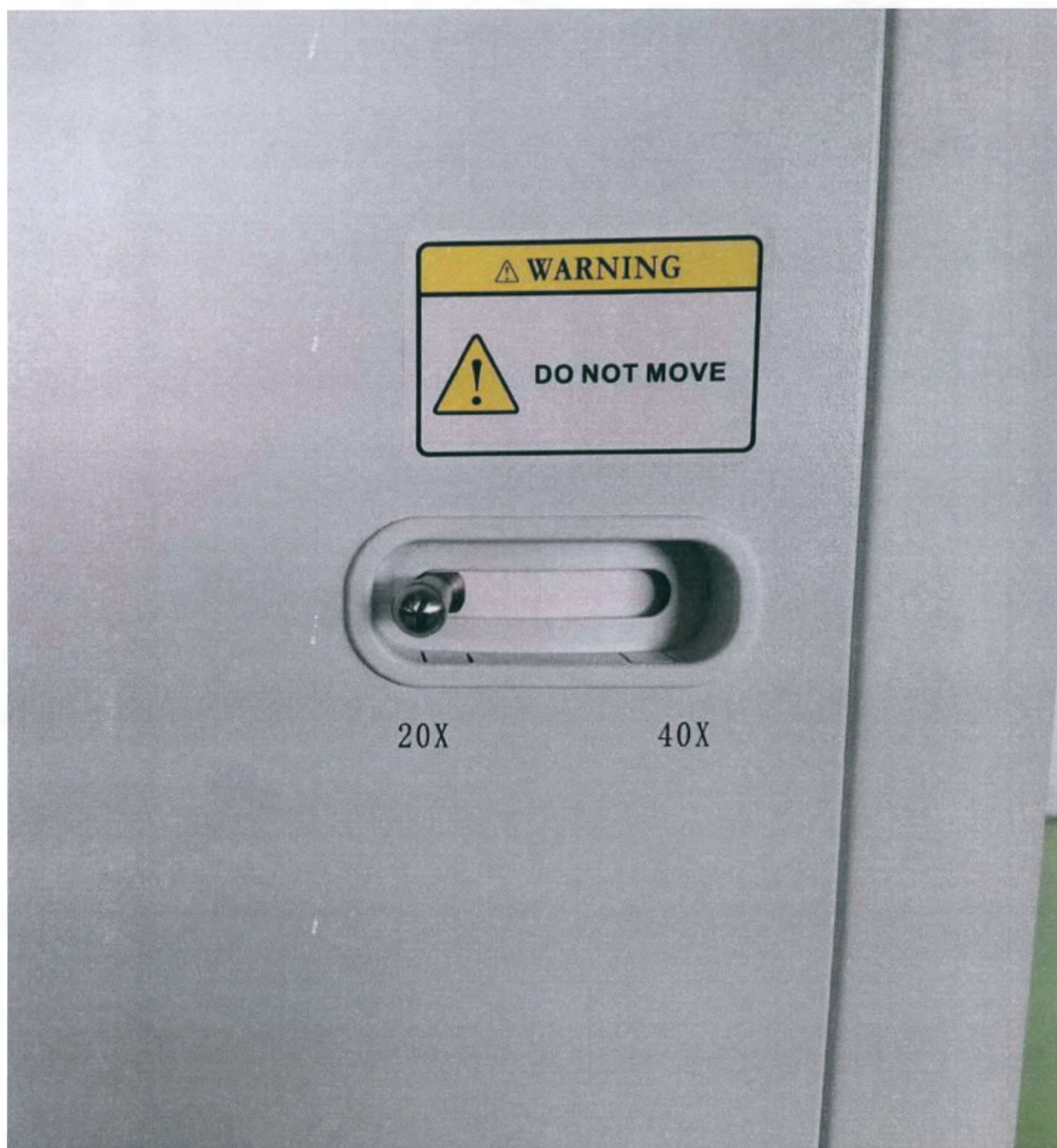
Фотографическое изображение 20 – Сканер цифровой патологоанатомический микропрепаратов (Digital Pathology Slide Scanner), вариант исполнения KF-PRO-005-III, переключатель масштаба
