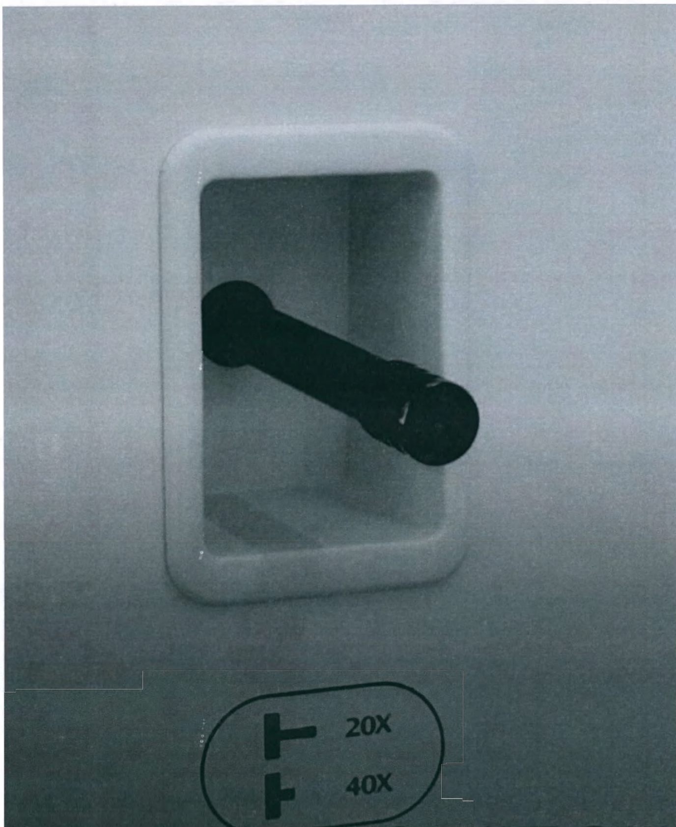
Фотографическое изображение 25 – Сканер цифровой патологоанатомический микропрепаратов (Digital Pathology Slide Scanner), вариант исполнения KF-PRO-020, переключатель масштаба
