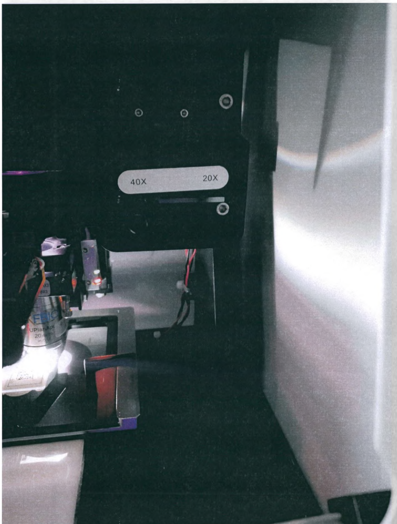
Фотографическое изображение 5 – Сканиер цифровой патологоанатомический микропрепаратов(Digital Pathology Slide Scanner), вариант исполнения KF-PRO-002, переключатель масштаба
