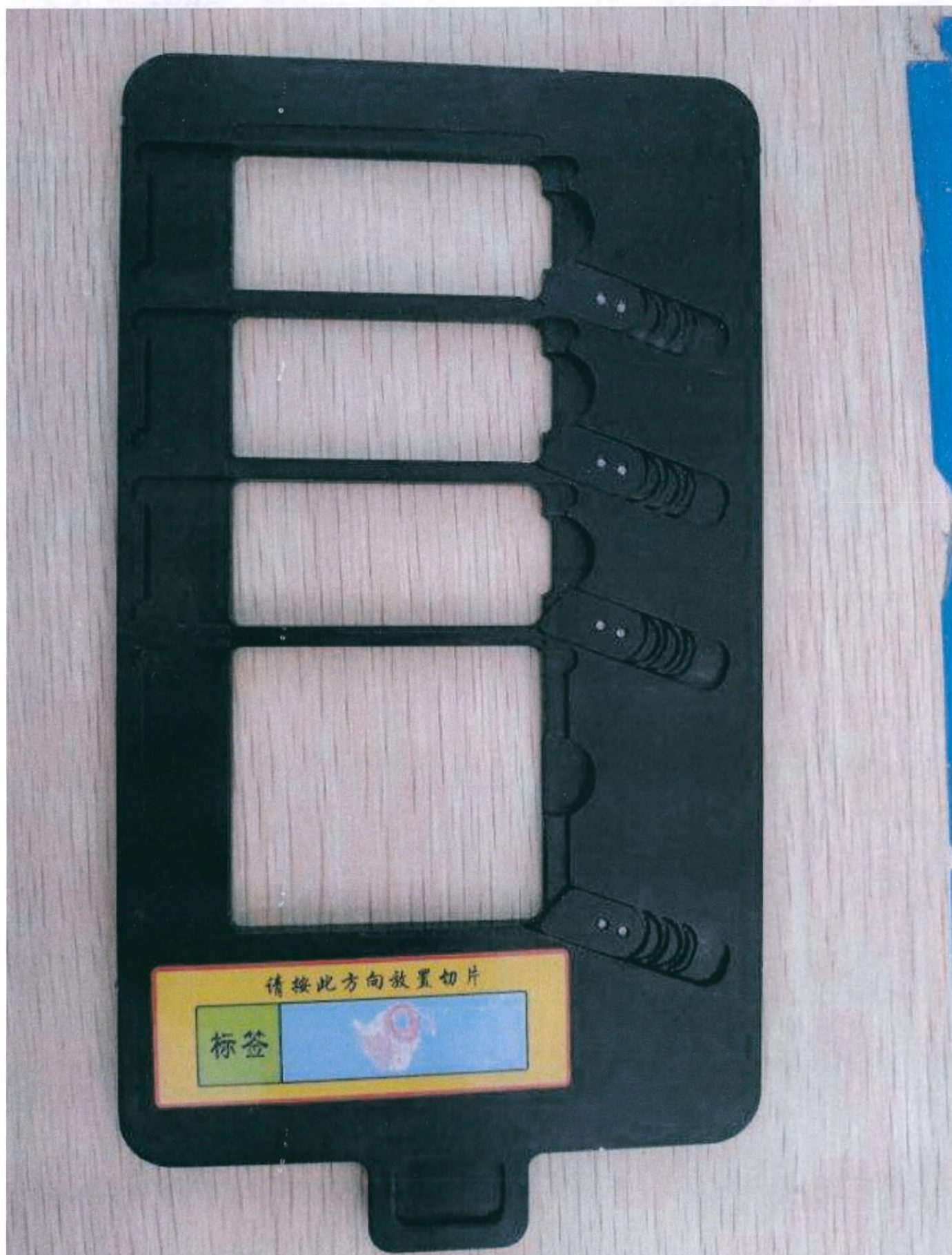
Фотографическое изображение 63 – Кассета на 4 слайда (1×3 дюйма, 2×3 дюйма), для сканера варианта исполнения KF-PRO-005-II
