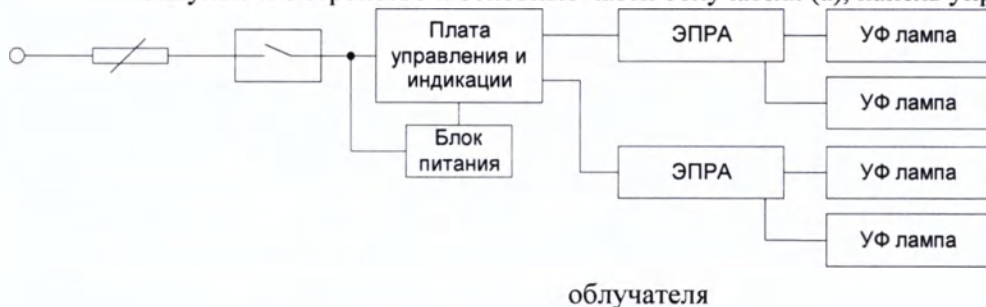
Рисунок 4. Устройство и основные части облучателя (а), панель управления (б)
