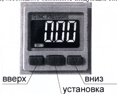
Общий вид датчика давления
