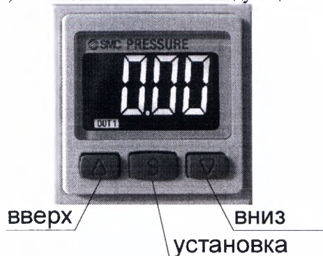
Общий вид датчика давления
