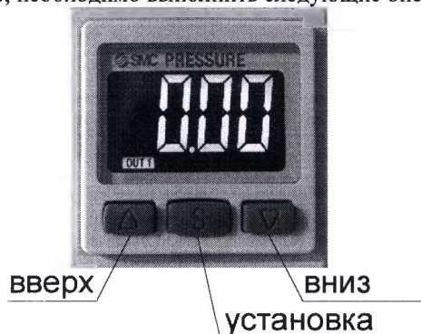
Общий вид датчика давления
