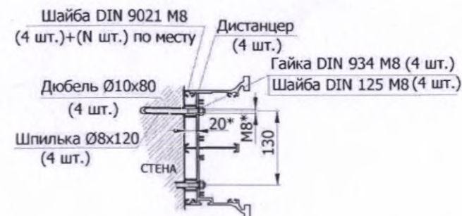
Рис. 5 Крепление настенной консоли
