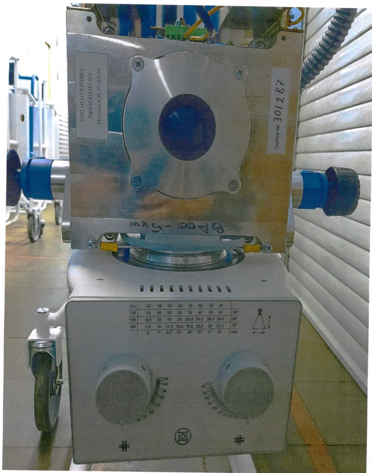
Рис 5. - Рентгеновский излучатель моноблочного типа модели ЛЖКМ.433251.002, производства ООО «С.П.ГЕЛПИК», Россия
